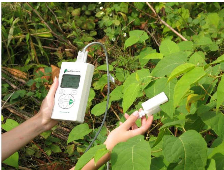
Slika 17: Izvedba meritev s porometrom SC-1, Decagon Devices, Pullman, Washington, ZDA (foto: T. Pačnik).
