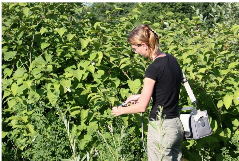
Slika 16: Izvedba meritev z modulacijskim Fluorometrom OS-500, Opti-Sciences, Tyngsboro, Massachusetts, ZDA (foto: T. Pačnik).
