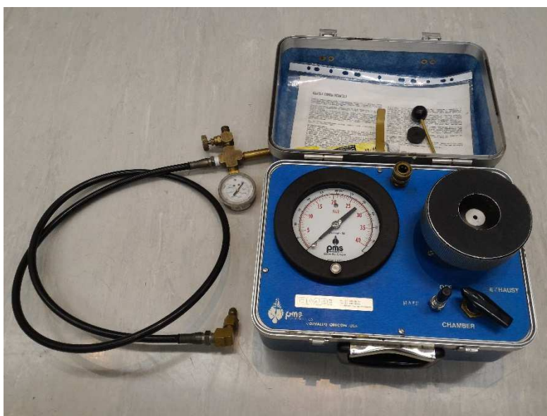
Slika 18: Scholanderjeva tlačna komora (foto: L. Pačnik).
