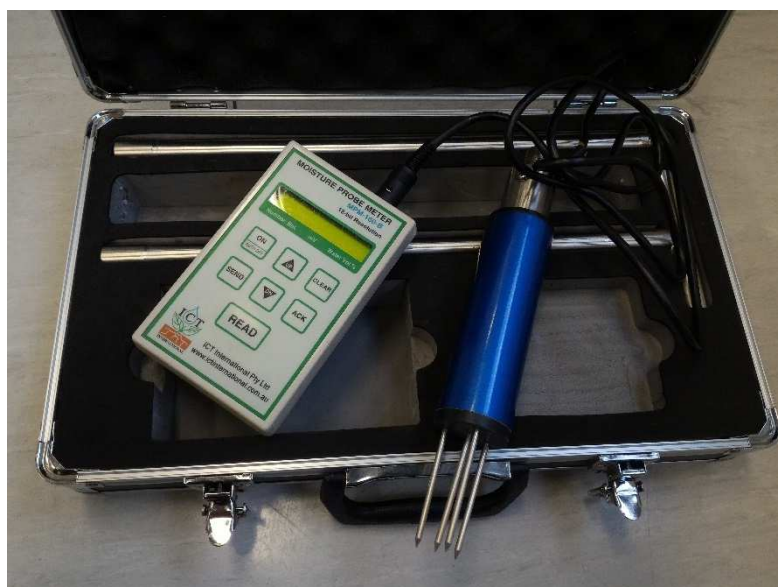
Slika 19: Tipalo za izvedbo meritev vlažnosti substrata MPM 160, ICT International Pty Ltd, Australia (foto: L. Pačnik).
