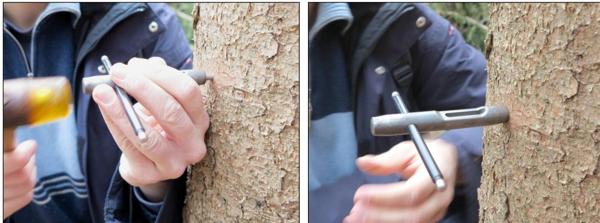
Slika 11: Zabijanje Trephorja v deblo (Foto: M. Merela).
