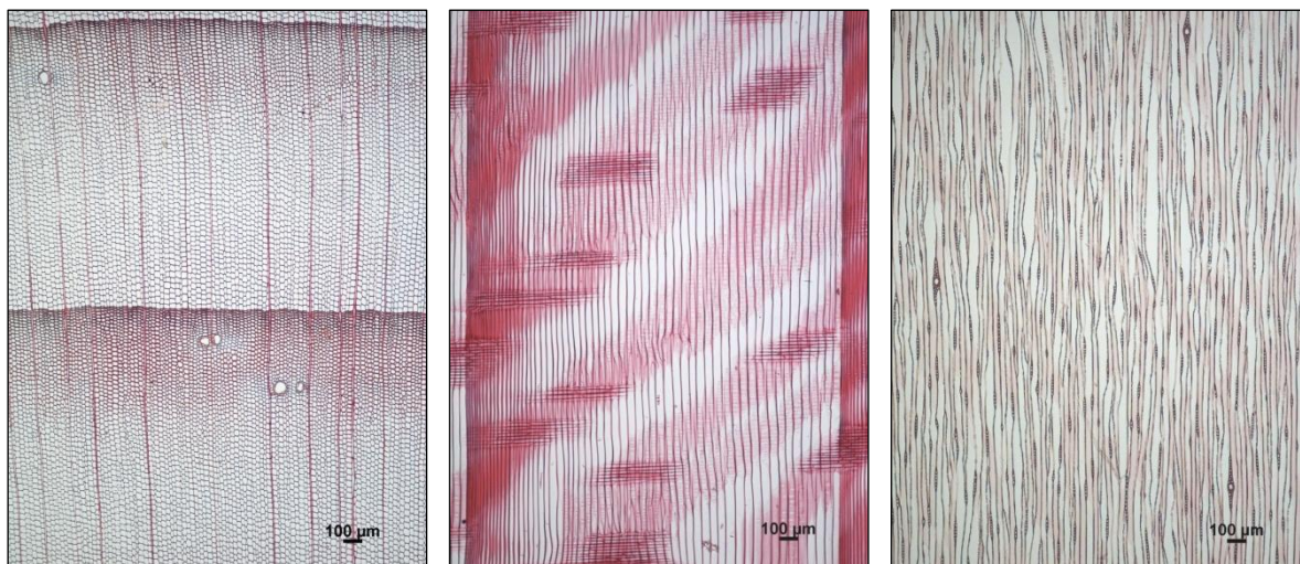
Slika 2: Prečni, radialni in tangencialni prerez smreke (od leve proti desni).
