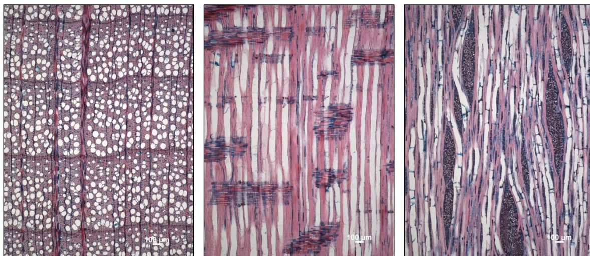
Slika 1: Prečni, radialni in tangencialni prerez lesa bukve (od leve proti desni).
