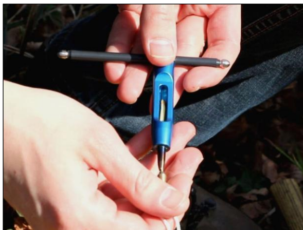
Slika 12: Mikroizvrtek se ujame v Trephor (Foto: M. Merela).
