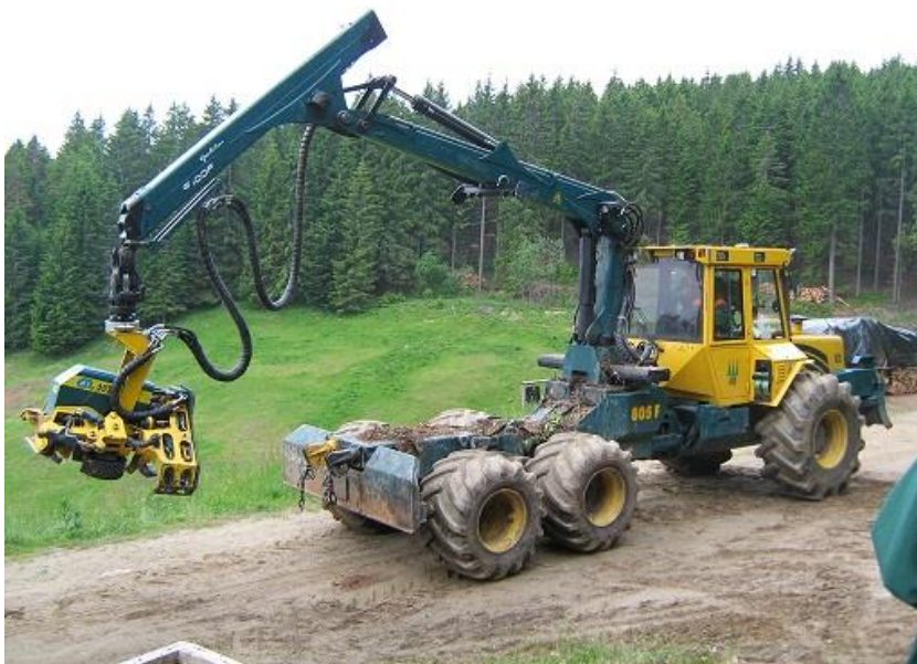
Slika 2: Kombinirani stroj za sečnjo HSM 805F v obliki stroja za sečnjo (foto: Mateja Intihar)
