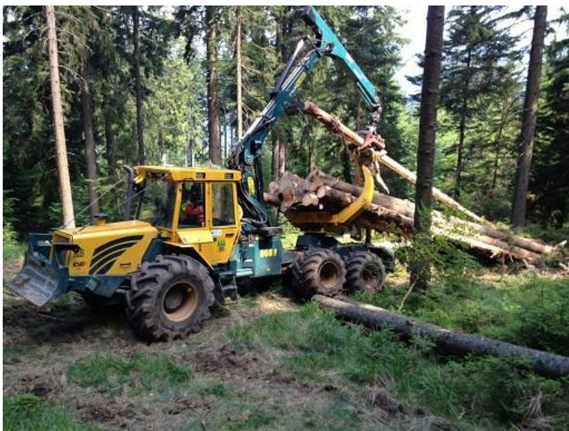
Slika 26: Spravilo lesa s sedlastim traktorjem (foto: Matevž Mihelič)
