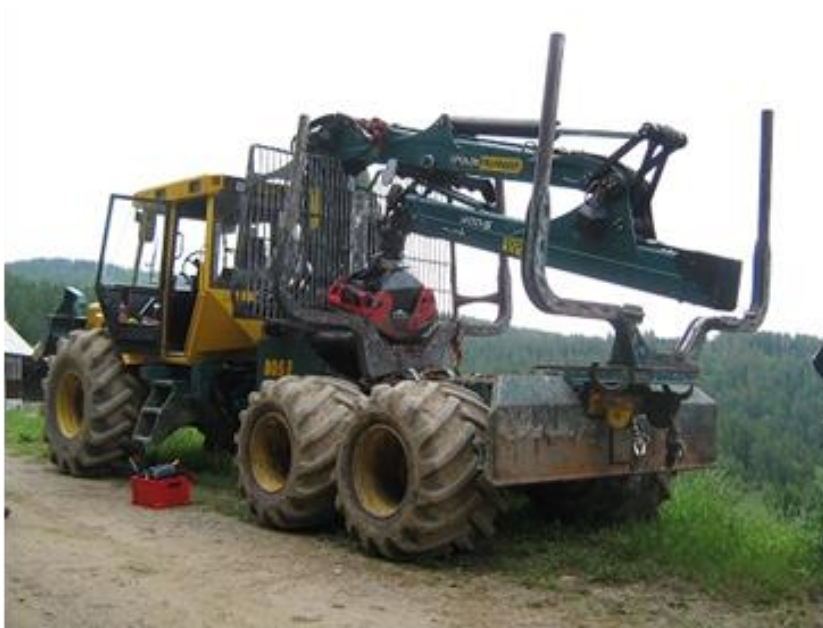
Slika 5: Vitel je na zadnjem delu stroja (foto: Mateja Intihar)
