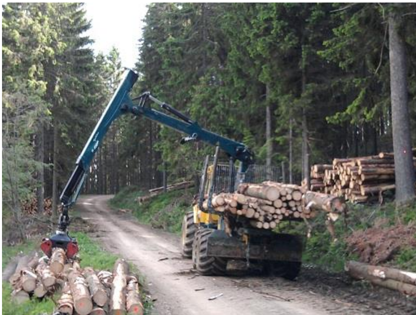
Slika 13: Vožnja lesa z zgibnim polprikoličarjem in sortiranje lesa (foto: Mateja Intihar)
