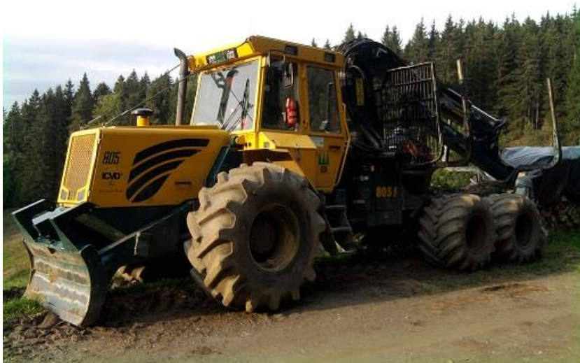
Slika 1: Kombinirani stroj za sečnjo HSM 805F v obliki zgibnega polprikoličarja (foto: Mateja Intihar)
