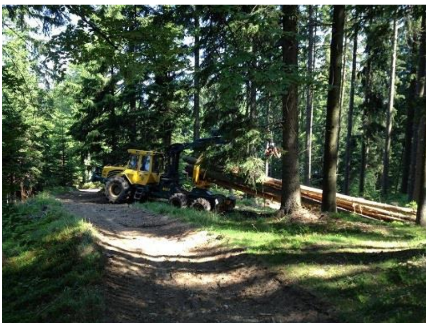
Slika 25: Spravilo s sedlastim traktorjem (foto: Matevž Mihelič)
