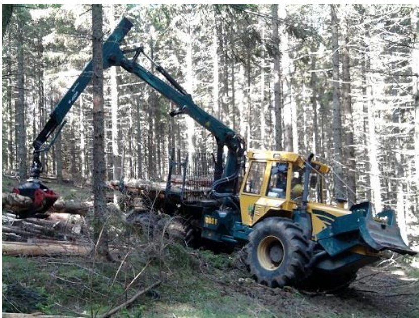
Slika 9: Vožnja lesa z zgibnim polprikoličarjem (foto: Mateja Intihar)
