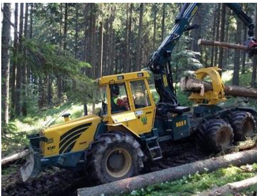
Slika 3: Kombinirani stroj za sečnjo HSM 805F v obliki sedlastega traktorja (foto: Matevž Mihelič)
