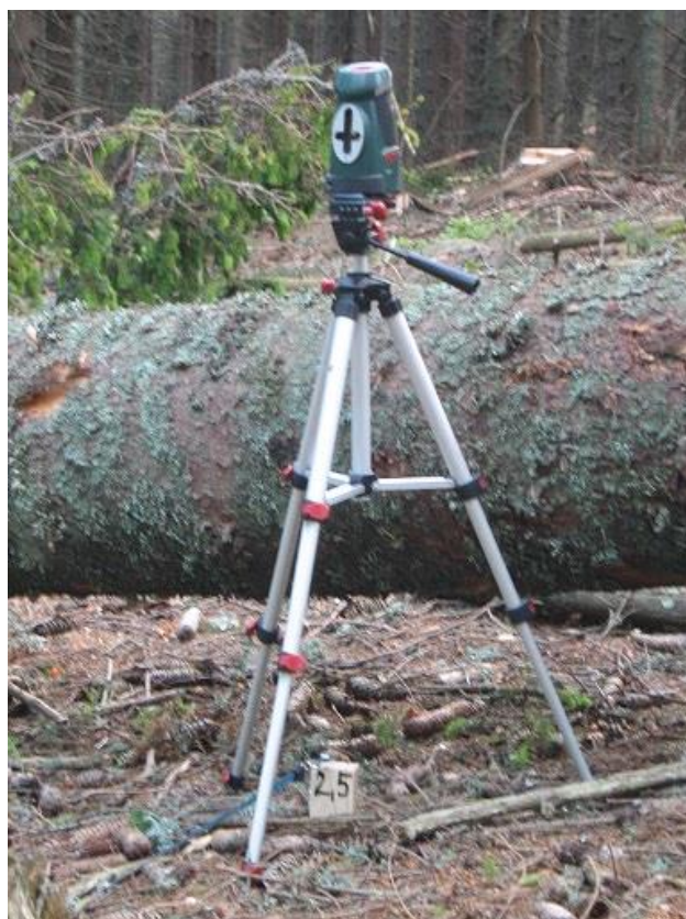
Slika 15: BOSCH križni linijski nivelirni laser (foto: Mateja Intihar)
