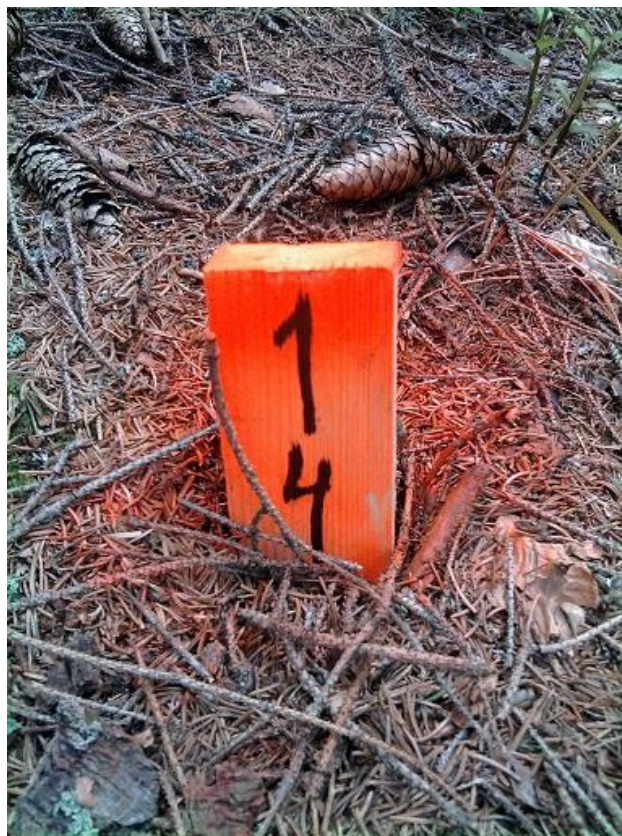
Slika 18: Leseni količki, dolžine 25 cm. Prva številka (1) označuje številko sečne poti, druga pa številko prečnega profila (4) (foto: Mateja Intihar)
