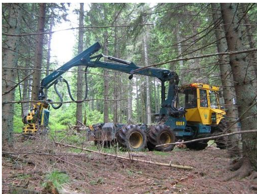
Slika 8: Sečnja lesa s strojem za sečnjo (foto: Mateja Intihar)
