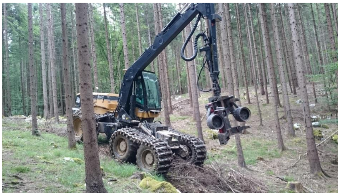
Slika 7: Stroj za sečnjo Caterpillar EcoLog 580C med premikom po sečnospravljeni poti, Mozelj (foto: Primož Meznarčič)
