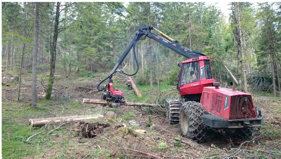
Slika 8: Stroj za sečnjo med izdelovanjem sortimenta in sekač, ki izvaja predsečnjo, Snežnik (Foto: Primož Meznarčič)
