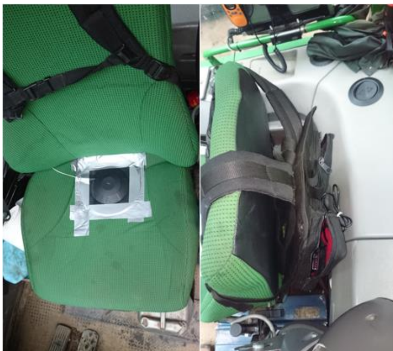
Slika 10: Adapter Brüel&Kjær 4515 nameščen na sedežu in merilna naprava v torbi za sedežem (foto: Primož Meznarčič)
