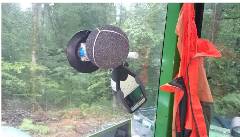
Slika 9: Naprava Brüel&Kjær 2250 za merjenje ropota nameščena na steklu v kabini stroja za sečnjo (foto: Primož Meznarčič)
