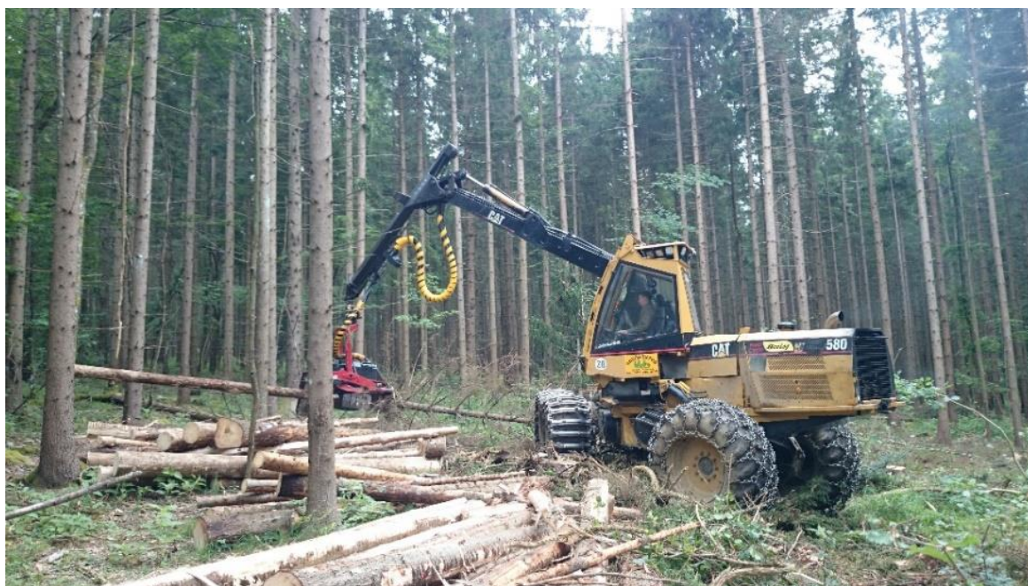
Slika 6: Stroj za sečnjo Caterpillar EcoLog 580 med procesiranjem, Željne-Laze (foto: Primož Meznarčič)
