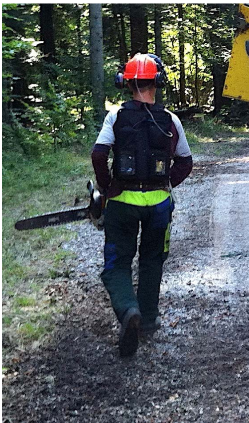
Slika 10: Nahrbtnik z merilnimi napravami za ergonomske raziskave v gozdarstvu
