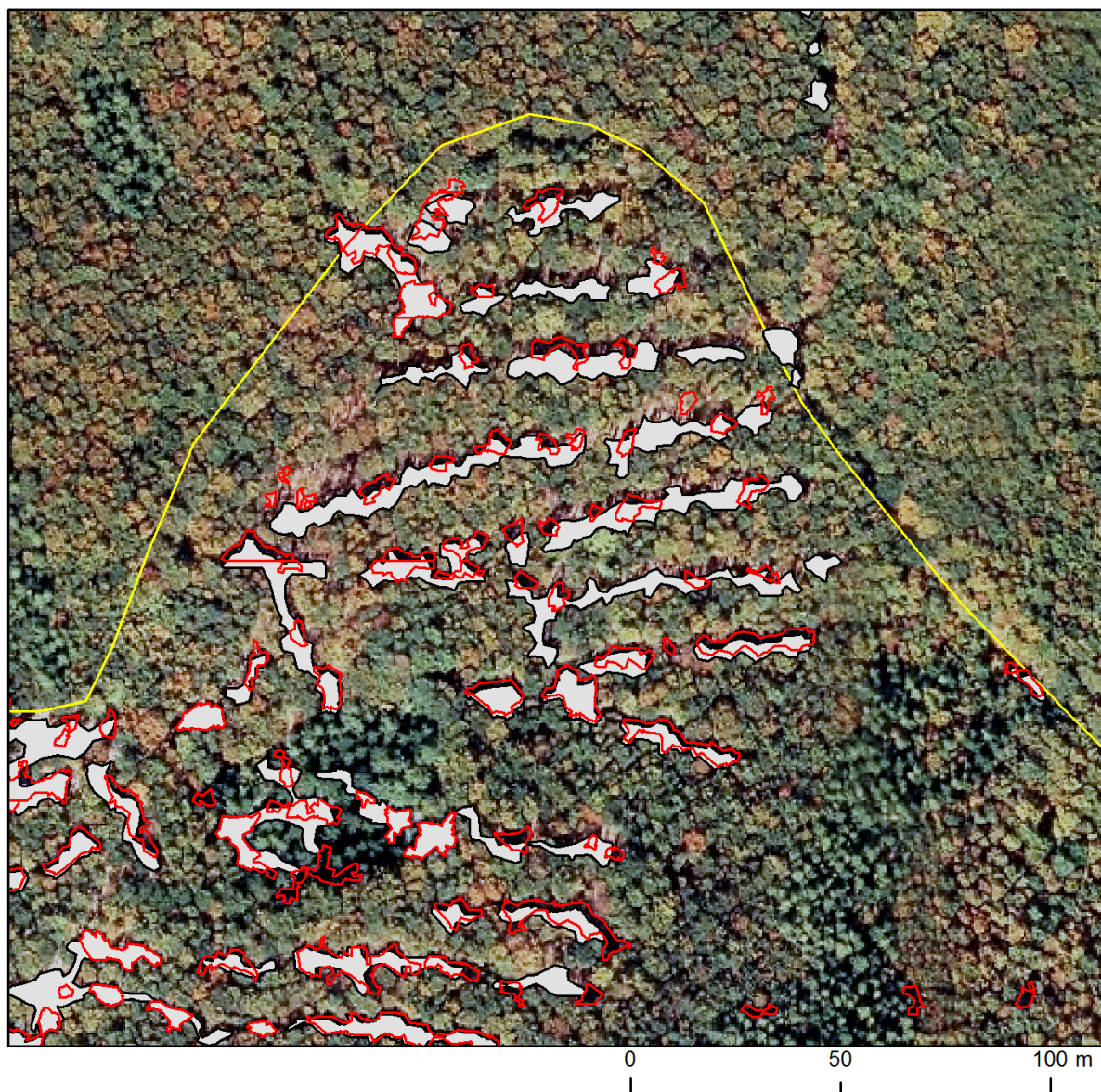
Slika 27: Prikaz izboljšane prostorske natančnosti z izdelavo karte vrzeli s pomočjo stereomodela (Vir: Digitalni ortofoto, Geodetska uprava RS, 2010; Prostorski podatki, ZGS, 2013)
