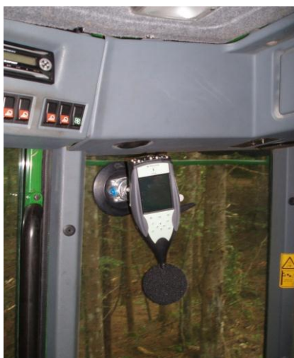
Slika 12: Položaj naprave Brüel&Kjaer 2250 za merjenje ropota v kabini zgibnega polprikoličarja
