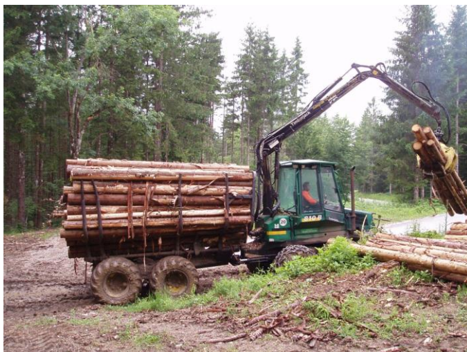
Slika 6: Timberjack 810B pri razkladanju bremena, Željne
