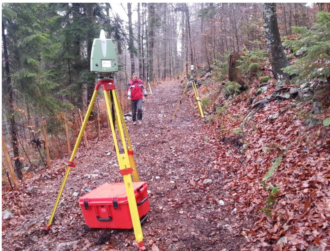
Slika 11: Leica Scanstation Type P20 med skeniranjem trase vlake
