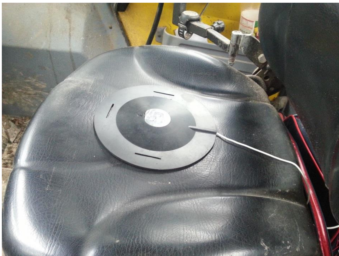
Slika 8: Adapter Breuel & Kjaer 4515-B-002 pritrjen na sedežu zgibnika
