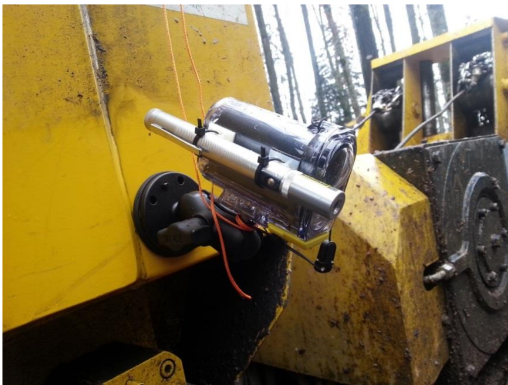
Slika 10: Kamera Sony, magnetno pričvrščena na bok zgibnega traktorja
