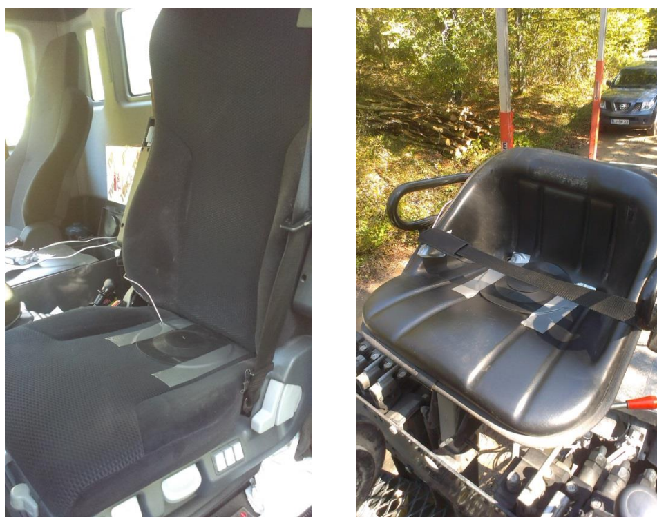
Slika 4: Položaj adapterja Brüel&Kjaer 4515 na sedežu v kabini (levo) ter na nakladalni napravi (desno) (Foto: Tomaž Žmuc).
