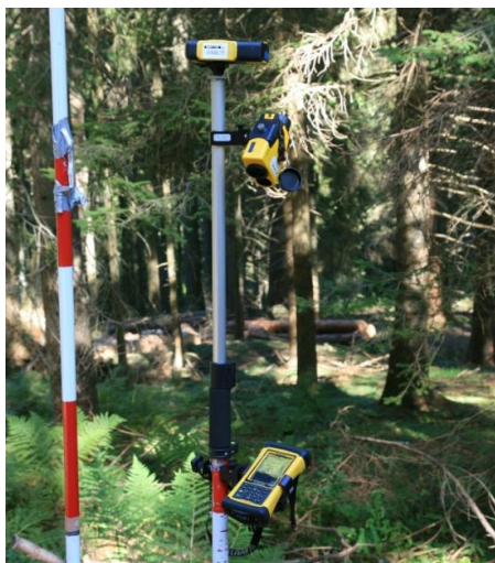
Slika 16: Elektronski merilnik razdalje in naklona TRUPULSE 360 (Foto: Stefano Grigolato)
