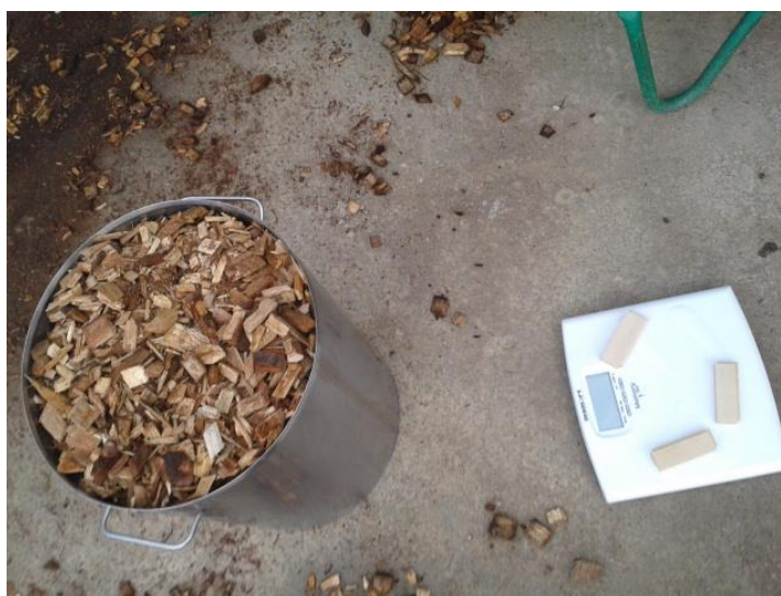
Slika 13: Vzorec za tehtanje gostote nasutja
