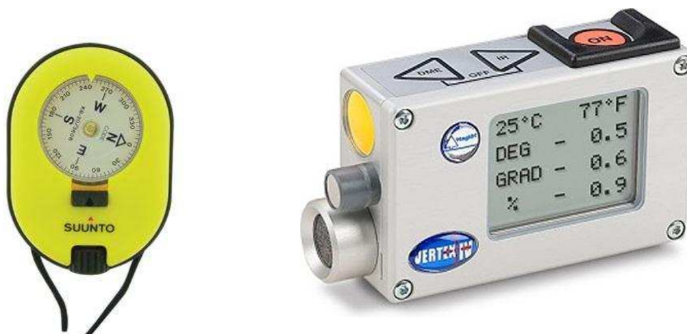
Slika 6: Kompas Suunto KB-20/R in višinomer HAGLOF Vertex IV (SUUNTO..., 2013, HAGLOF..., 2013)
