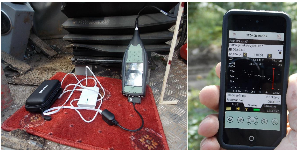
Slika 3: Merilna naprava Bruel & Kjaer 2250 (Foto: Dimnik Anton)
