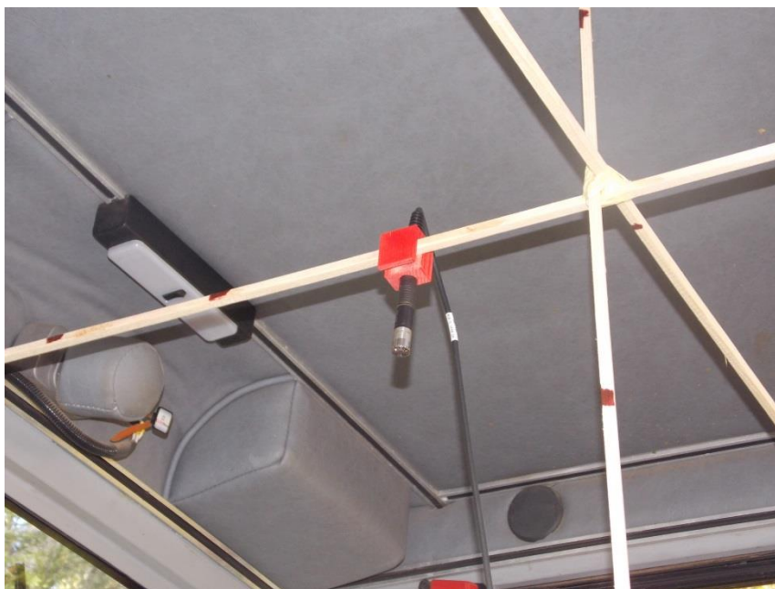
Slika 4: Precizni mikrofoni Bruel & Kjaer 4189 (Foto: Dimnik Anton)
