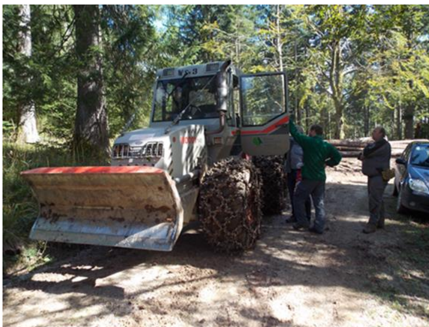
Slika 2: Gozdarski zgibni traktor Woody 140 (Foto: Dimnik Anton)
