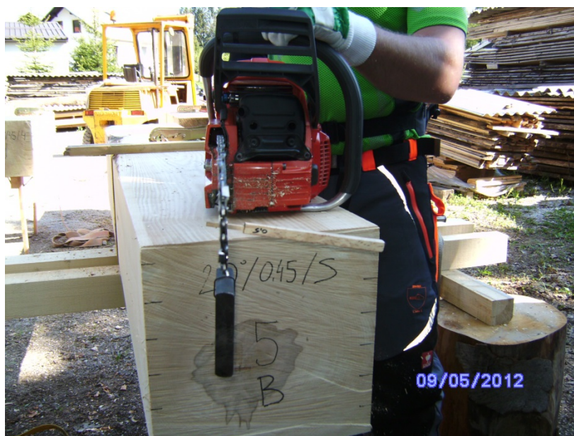
Slika 7: Preverjanje napetosti verige (Foto: M. Dužnik)
