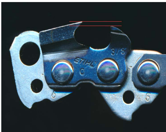
Slika 6: 0,85 mm znižan globinski zob (Foto: Foto Atelje Postojna)
