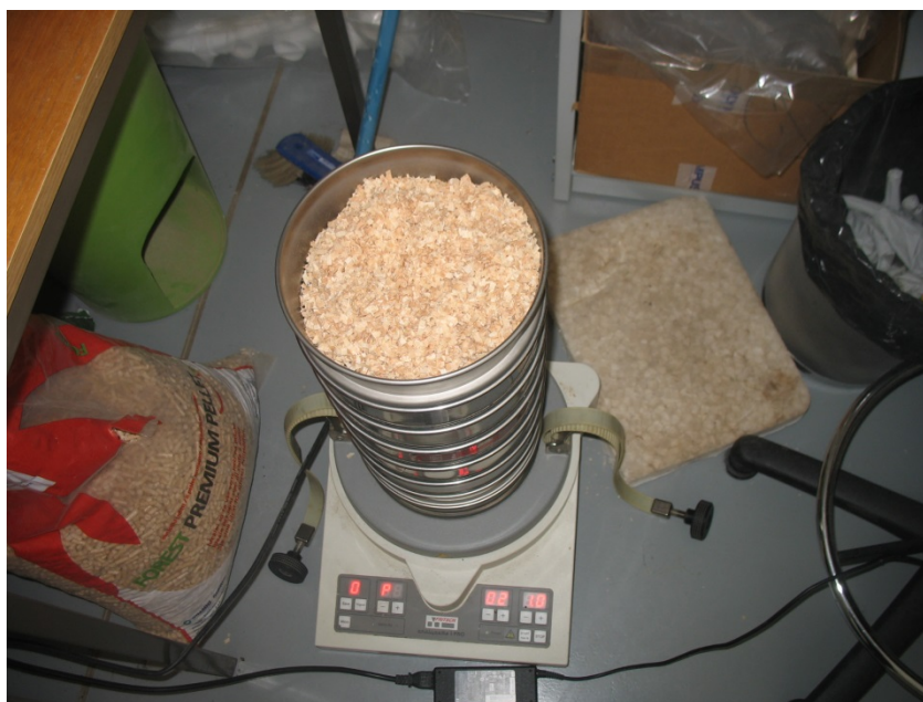
Slika 12: Presejalnik žagovine (Foto: M. Dužnik)
