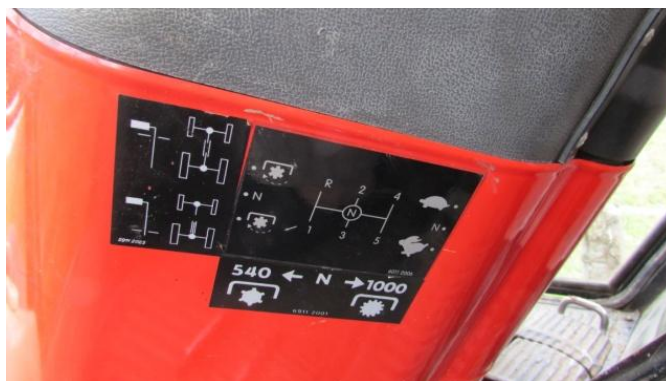
Slika 25: Informacije o delu z menjalnikom, vrtljivo gredjo in štirikolesnim pogonom pri starejšem traktorju
