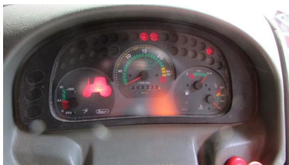
Slika 24: Nadzorna plošča z opozorilnimi lučkami pri novejšem traktorju
