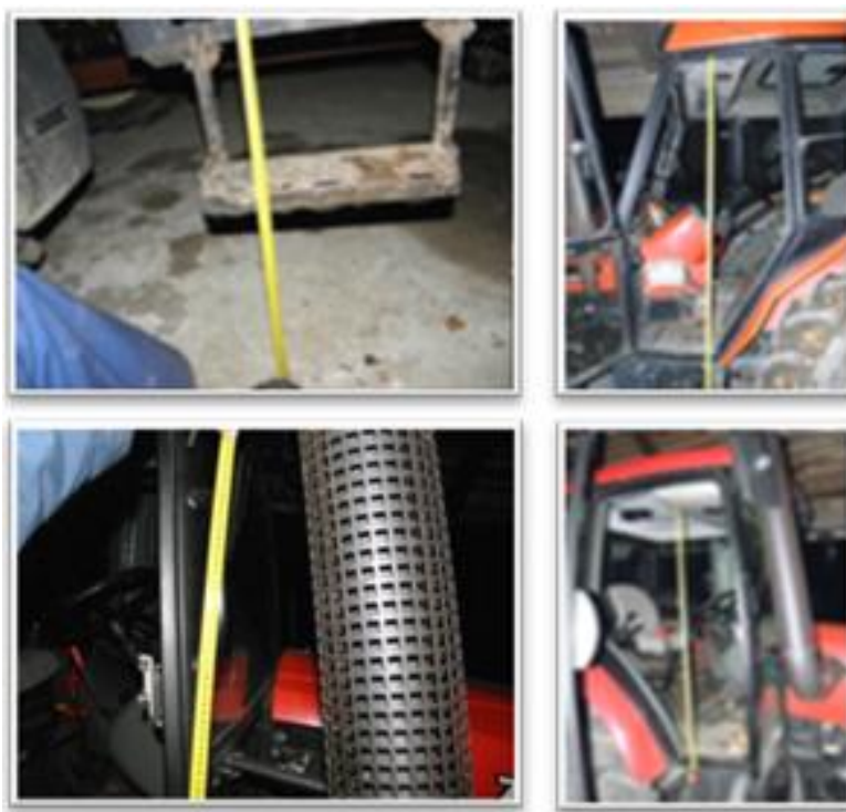
Slika 10: Merjenje razdalje do prve stopnice (levo zg.) do ročaja (levo sp.) ter merjenje višine vrat (desno zg. in sp.)
