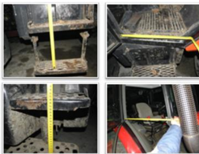
Slika 9: Merjenje razdalje med stopnicama (levo zg. in levo sp.) in merjenje širine vrat (desno zg. in desno sp.)
