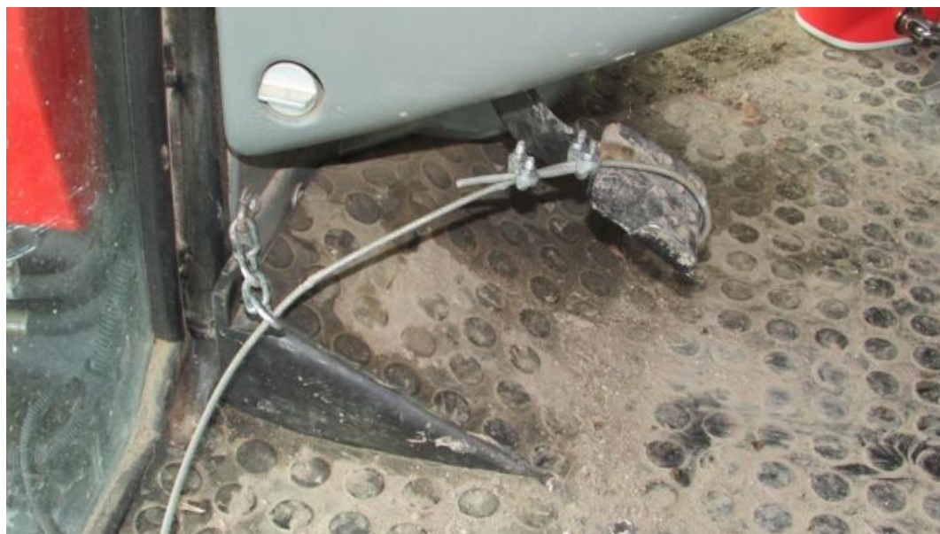
Slika 21: Prikaz napeljave jeklene vrvi za merjenje sile sklopke pri novejšem traktorju s pomočjo škripca
