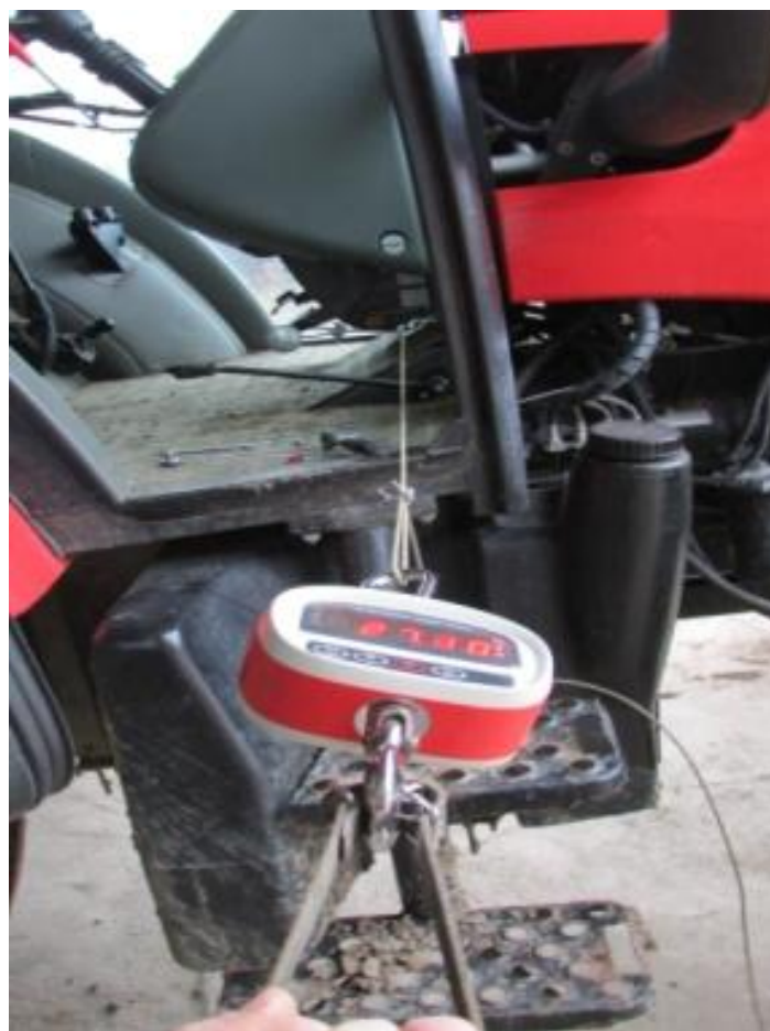
Slika 22: Merjenje sile sklopke pri novejšem traktorju
