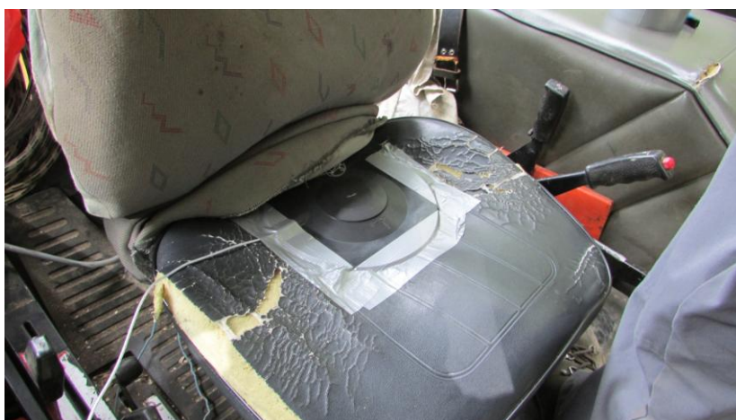
Slika 30: Namestitev tipala za merjenje tresljajev pred pričetkom merjenja
