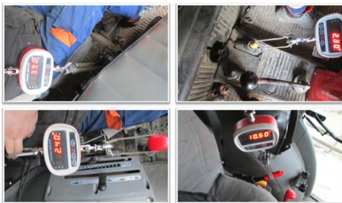
Slika 23: Merjenje sil različnih vodil v traktorjih: vodilo za premik priključka, pripetega na tritočkovni priklop (levo zg.), vodilo za vklop premične gredi (desno zg.), ročica inverterja (levo sp.) in ročna zavora (desno sp.)
