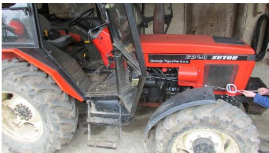
Slika 20: Prikaz merjenja sile nožne zavore s pomočjo jeklene vrvi
