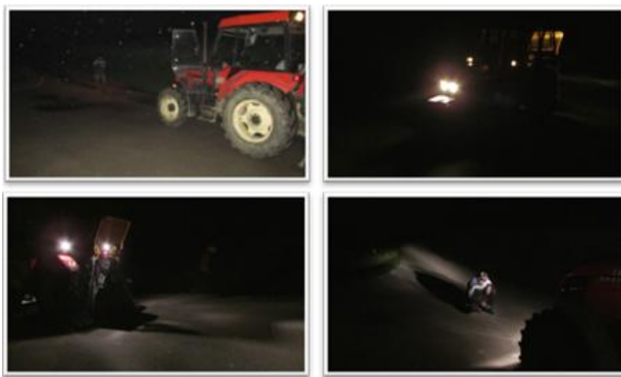
Slika 36: Merjenje osvetljenosti pred (levo in desno zg., desno sp.) in za traktorjem (levo sp.)
