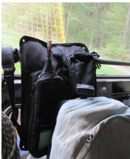
Slika 28: Namestitev naprav za merjenje ropota in tresenja v traktorju
