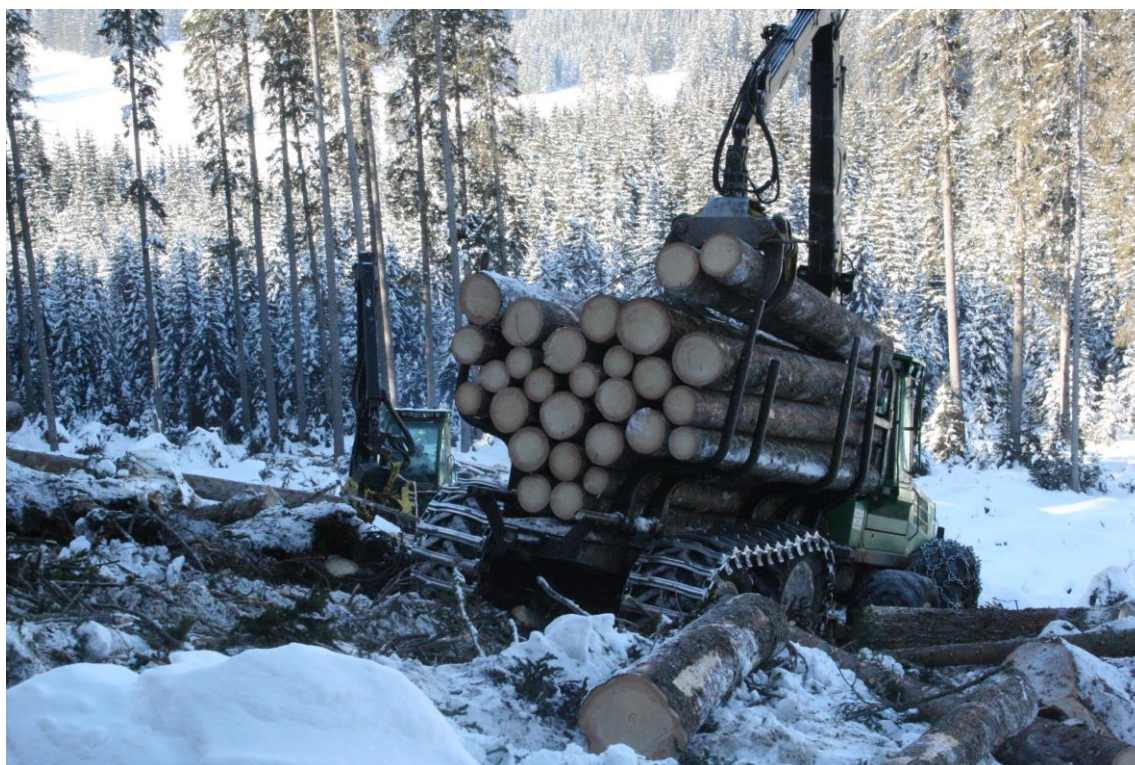
Slika 5: Zgibni polprikoličar za spravilo lesa – forwarder (Foto: J. Primožič)
