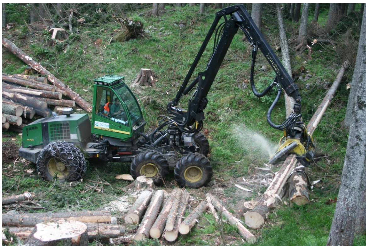
Slika 4: Stroj za sečnjo – harvester (Foto: J. Primožič)
