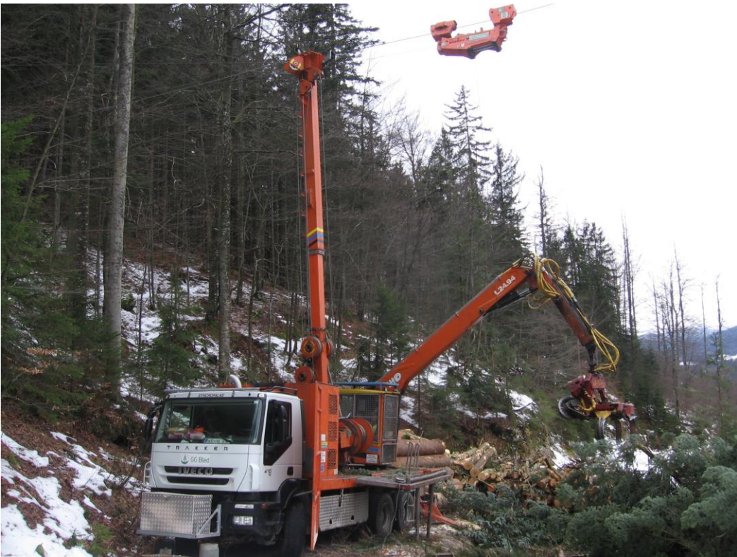
Slika 6: Gozdarska žičnica za spravilo lesa – Syncrofalke
