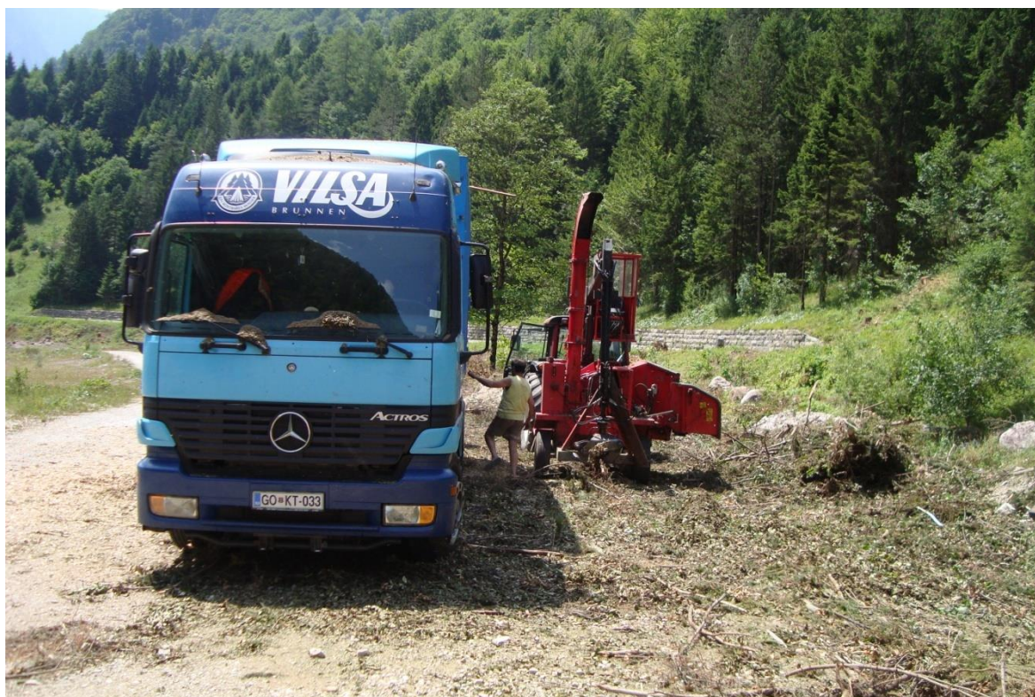
Slika 8: Primerno urejeno delovišče listavcev, kjer je bila vejevina listavcev zmleta s sekalnikom
