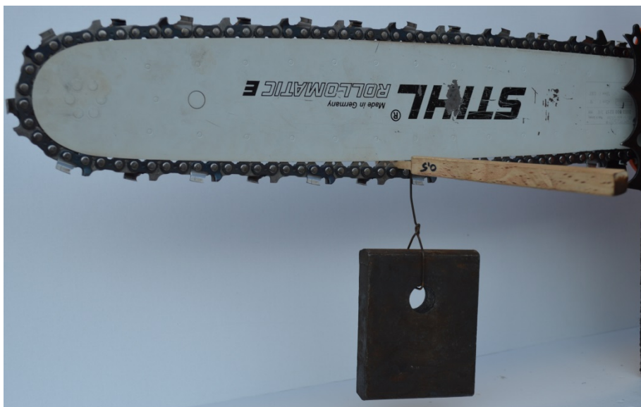
Slika 12: Preverjanje napetosti verige s pomočjo uteži in šablone (Foto: Ž. Švigelj)
