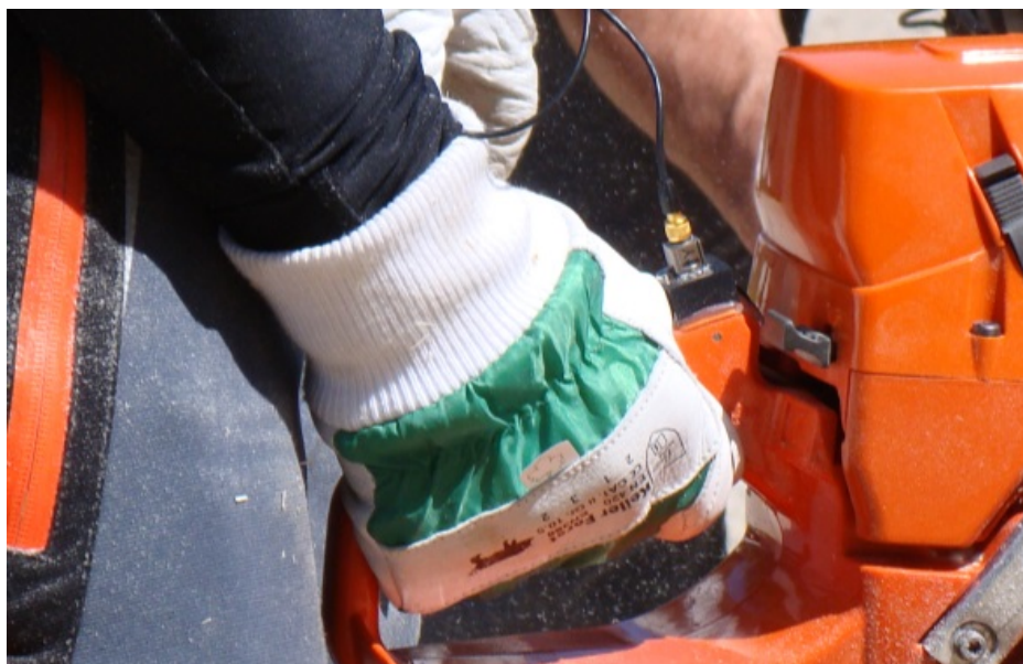
Slika 14: Položaj akcelometra na vodilnem ročaju za potrebe meritev ( Foto: A. Poje)
