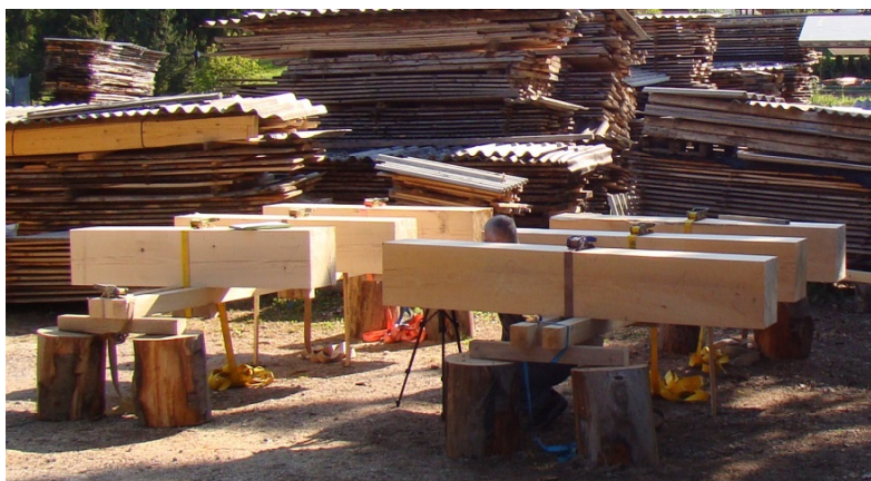
Slika 1: Postavitev prizem jelke in bukve na stojala in prikaz načina vpetja prizem (Foto: M. Dužnik)
