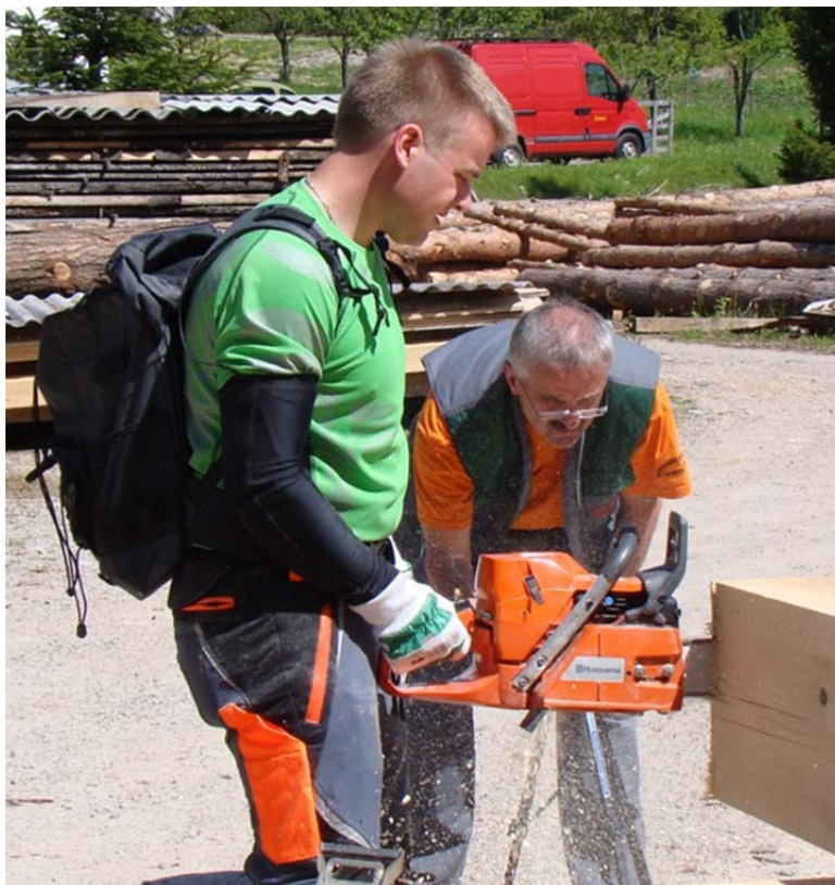
Slika 13: Položaj nahrbtnika, v katerem je merilna naprava med meritvijo ( Foto: M. Dužnik)
