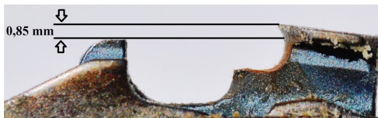
Slika 11: Globinski zob znižan za 0,85 mm (Foto: Ž. Švigelj)
