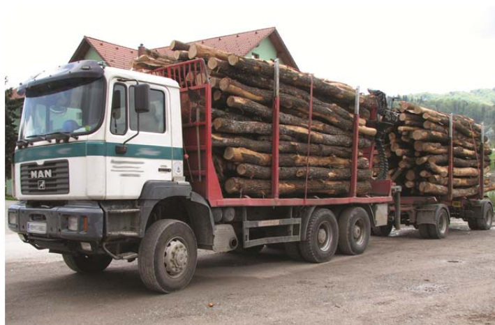
Slika 40: GTK 6 s pogonom 6x6. (Foto: R. Ferle)
