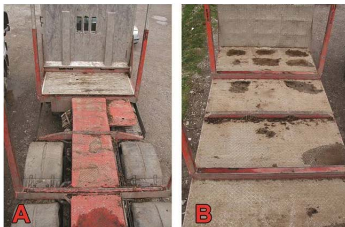
Slika 15: Tovorni prostor A: brez platoja in B: s platojem. (foto: R. Ferle)
