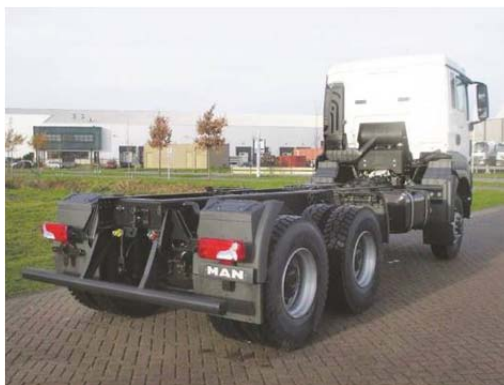
Slika 8: Osnovna šasija brez nadgradnje. (PK trucks, 2016)
