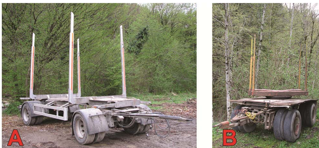
Slika 26: A-Prikolica za prevoz kratkega lesa ; B-(Pol)prikolica z vrtljivo klopjo za prevoz dolgega lesa (biling). (foto: R. Ferle)
