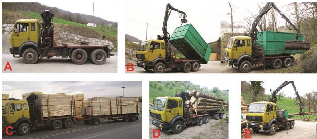
Slika 44: Večnamensko vozilo. A: Sedlasti vlačilec, B: Nakladanje in transport sipkih tovorov, C: Prevoz kratkega lesa in žagarskih polizdelkov, D: Prevoz dolgega lesa, E: Izdelava sekancev. (foto: R. Ferle)
