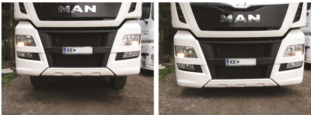
Slika 11: Reguliranje nivoja podvozja pri zračnem vzmetenju. (foto: R. Ferle)
