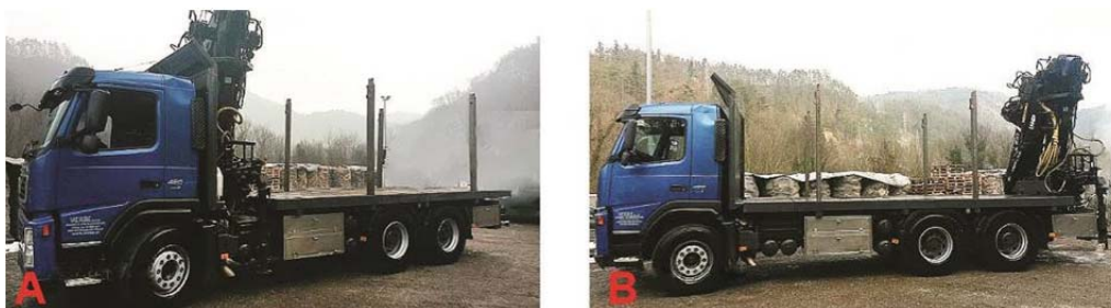
Slika 21: Vozilo s pomičnim dvigalom. A: za kabino, B: na previsu. (foto: B. Verbe)
