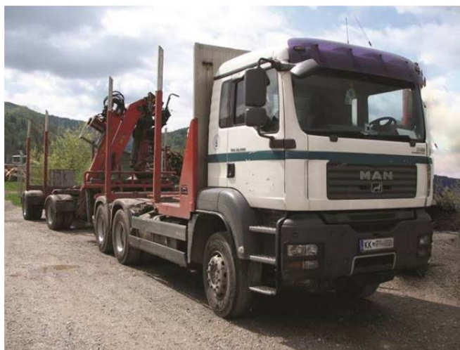
Slika 42: Lahka izvedba GTK z osno konfiguracijo 6x4. (foto: R. Ferle)
