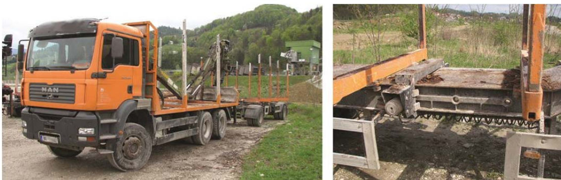
Slika 41: GTK z raztegljivo prikolico. (foto: R. Ferle)
