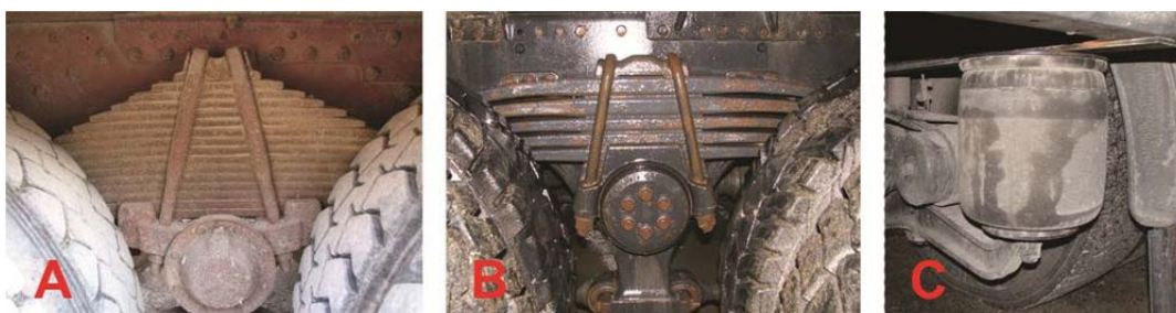
Slika 10: Vrste vzmetenj, A: listnato-trapez, B: listnato-parabola, C: zračno vzmetenje. (foto: R. Ferle)
