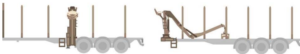
Slika 20: Mesto namestitve dvigala na polprikolici. (ilustr.: N. Oman)
