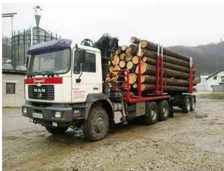
Slika 38: Predelava nadgradnje iz sistema dolgega v kratek les. (foto: S. Jermančič)
