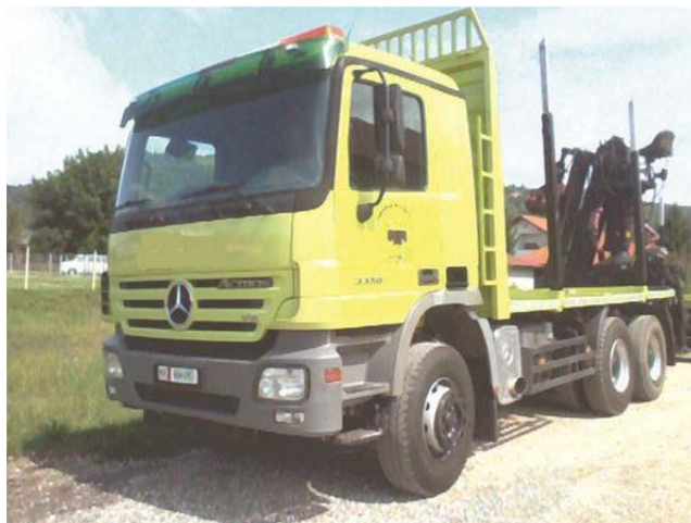
Slika 39: GTK 2 s krajšo medosno razdaljo inkrajšim nakladalnim platojem. (Foto: L. Kozinc)
