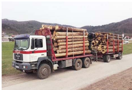
Slika 38: Predelava nadgradnje iz sistema dolgega v kratek les. (foto: S. Jermančič)
