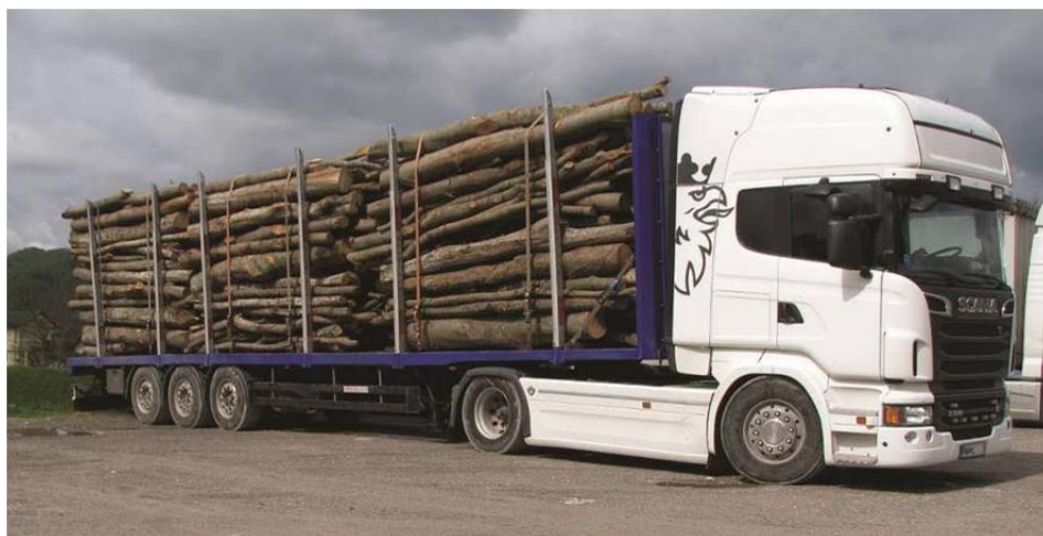
Slika 7: GTK (sedlasti vlačilec s polprikolico) brez nakladalne naprave za prevoze na daljših razdaljah. (foto: R. Ferle)
