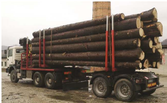
Slika 27: GTK s tandem polprikolico za prevoz dolgega lesa. (foto: S. Jermančič)
