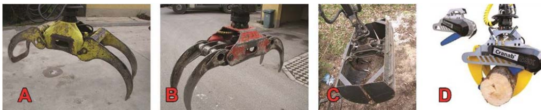
Slika 22: Tipi grabežev, A: za okrogel les, B: za vejevino, C: dodatek klasičnemu grabežu za manipulacijo sipkih tovorov (foto: R. Ferle); D: za prežaganje.(Cranab harvester cranes, 2016)
