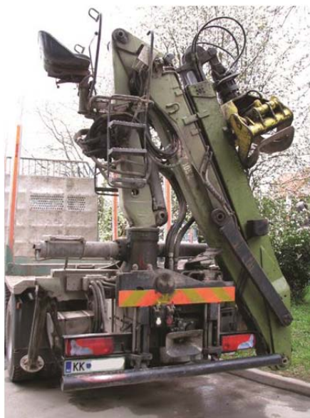
Slika 18: Hidravlično dvigalo zloženo v transportnem položaju "Z". (foto: R. Ferle)
