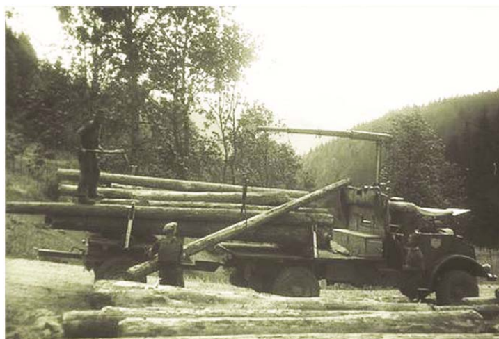
Slika 5: Kombinirani hidravlično-žični žerjav. (Forstmuseum, 2016)
