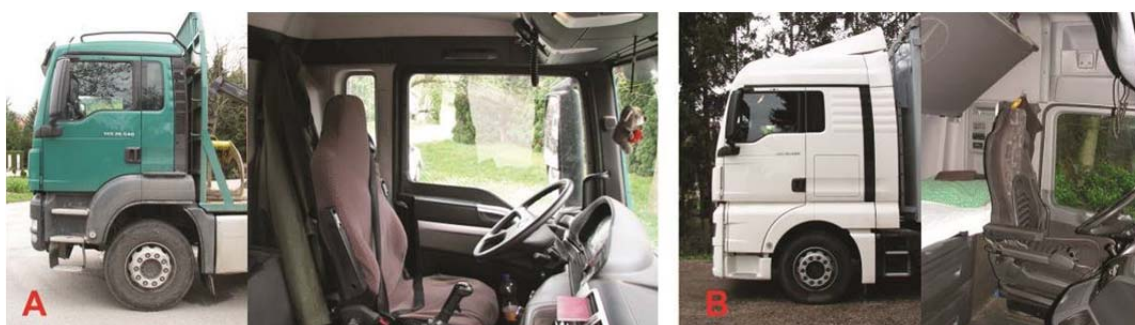
Slika 13: Tipi kabin, A: Dnevna kabina, B: Spalna kabina. (foto: R. Ferle)
