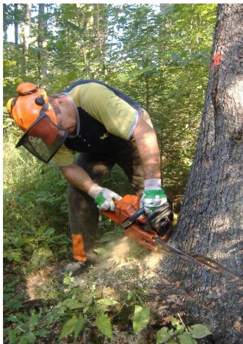
Slika 4: Podiranje drevesa z motorno žago Husqvarna 372 XP (Foto: Gorišek B.)
