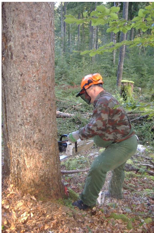
Slika3: Podiranje drevesa z motorno žago Stihl MS 361 (Foto: Gorišek B.)
