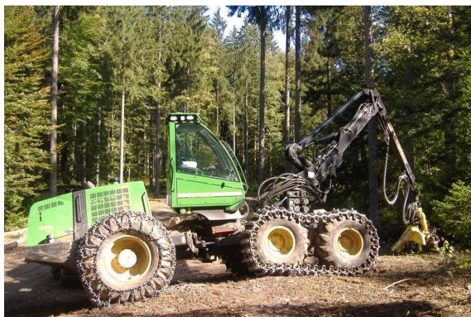
Slika 5: Stroj za sečnjo JOHN DEERE 1470D ECO III (Foto: Gorišek B.)
