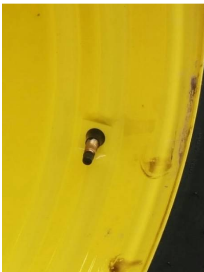
Slika 23: Tovarniški ventil (Foto: Kotar M.)
