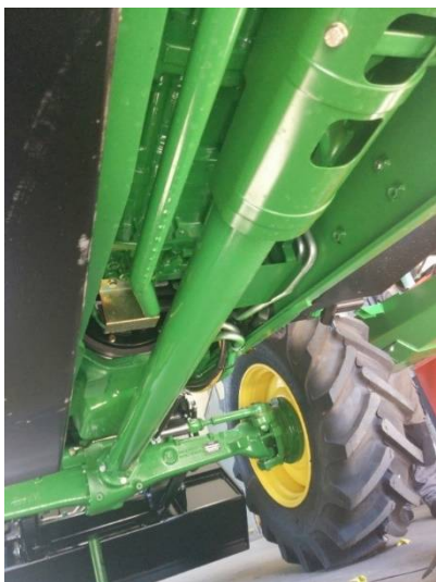
Slika 43: Nezaščiten kardanski drog in podvozje traktorja (Foto: kotar M.)
