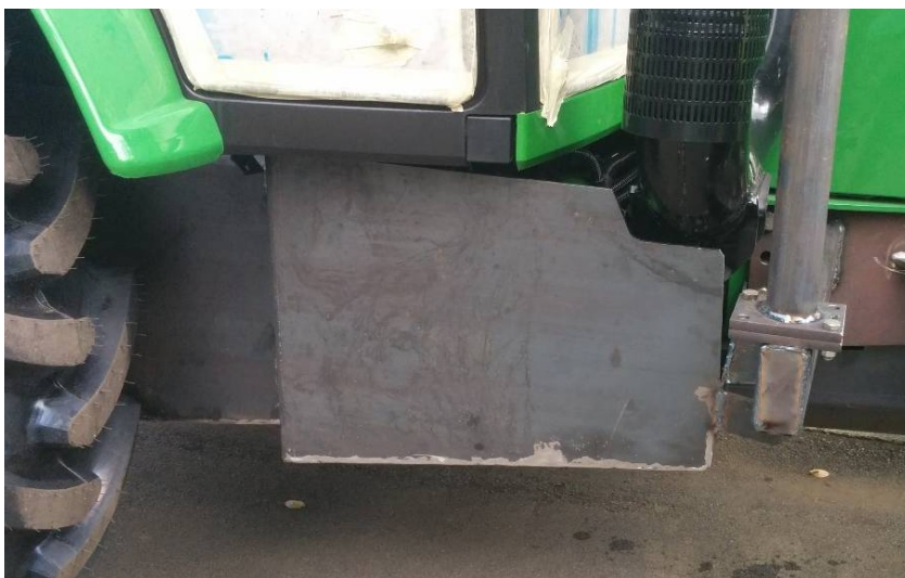
Slika 38: Nameščena zaščita akumulatorja in hidravličnega seta (Foto: Kotar M.)
