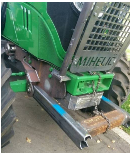
Slika 29: Namestitev mosta prednje rampne deske (Foto: Kotar M.)
