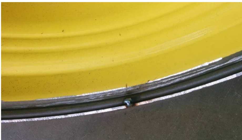
Slika 25: Vstavljen dodatni obroč (Foto: Kotar M.)
