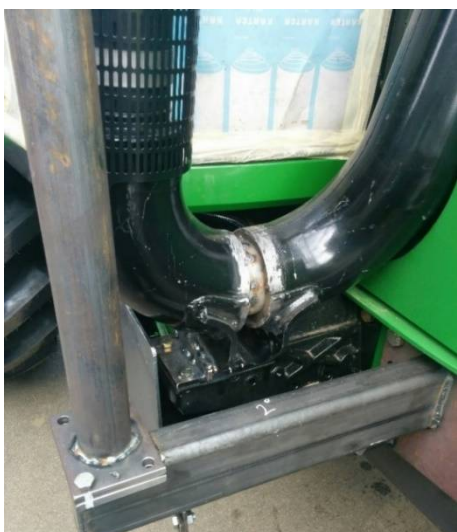
Slika 17: Po meri predelani izpuh (Foto: Kotar M.)
