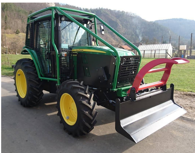
Slika 46: Končana nadgradnja sprednje strani (Foto: Kotar M.)
