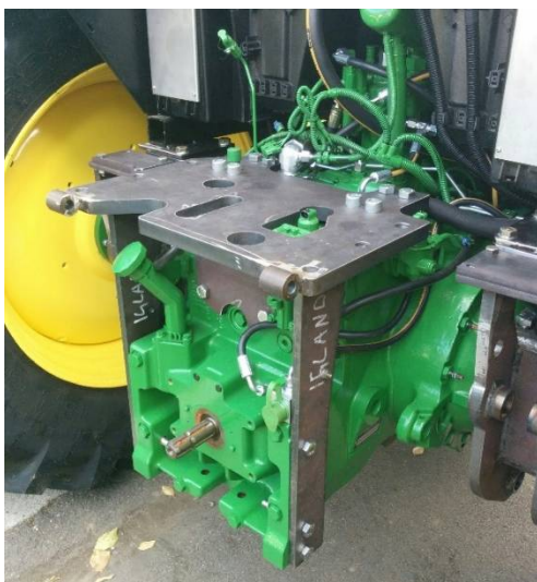
Slika 37: Namestitev osnovne police vitla (Foto: Kotar M.)
