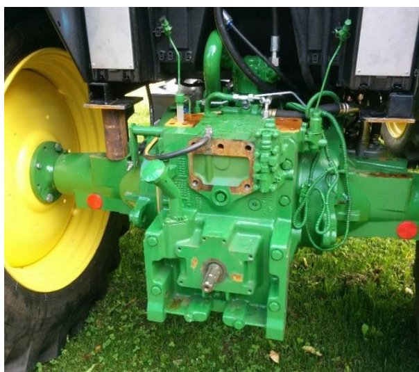
Slika 36: Odstranjeni hidravlični set ventilov (Foto: Kotar M.)
