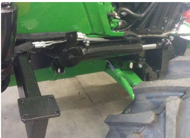
Slika 31: Namestitev hidravličnih cilindrov prednje rampne deske (Foto: Kotar M.)
