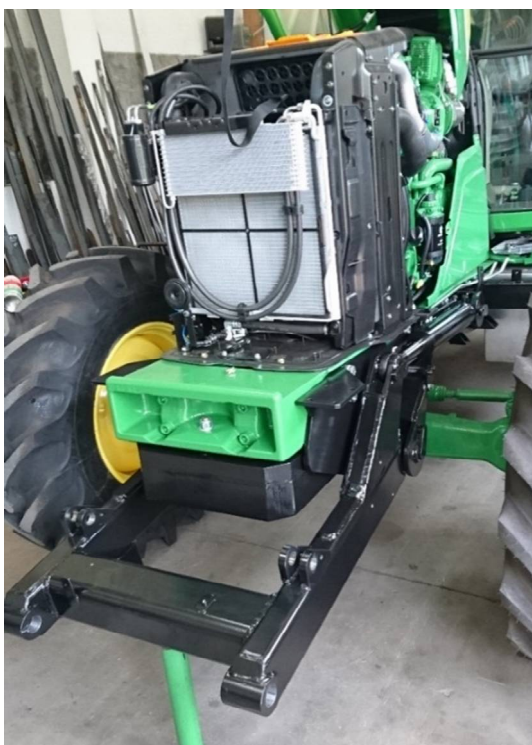
Slika 30: Nameščeni dokončani most prednje rampne deske (Foto: Kotar M.)
