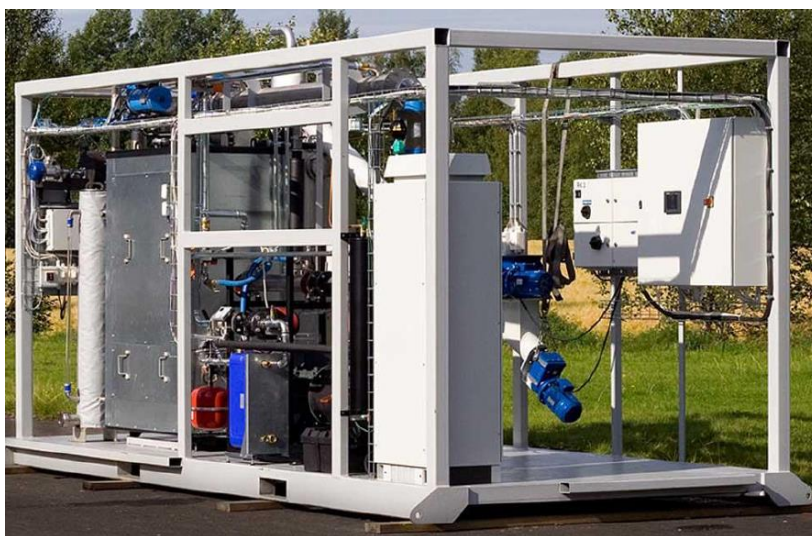
Slika 2: Kogeneracijski sistem Volter 30 pred vgradnjo (Biomass based ..., 2016: 7)
