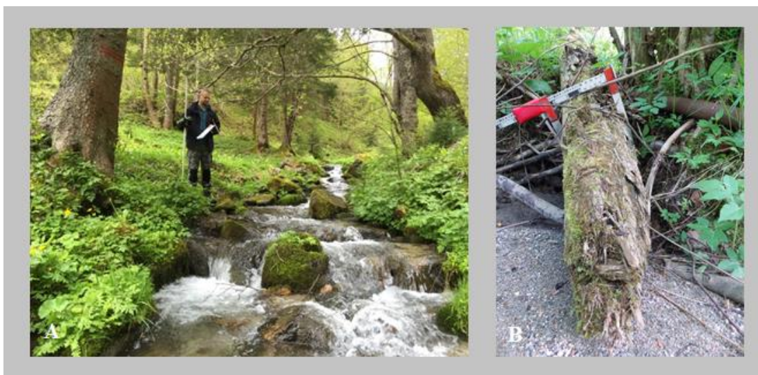
Slika 33: Geolociranje lesenega plavja z napravo GNSS v povirju Meže (A). Foto: Milan Kopal. Kos lesenega plavja, ki ga je v času visokih vod tok transportiral in odložil na prodišče v enem od zavojev Meže. S premerko smo mu na polovici njegove dolžine izmerili premer (B). Foto: Tadej Lamprecht.
