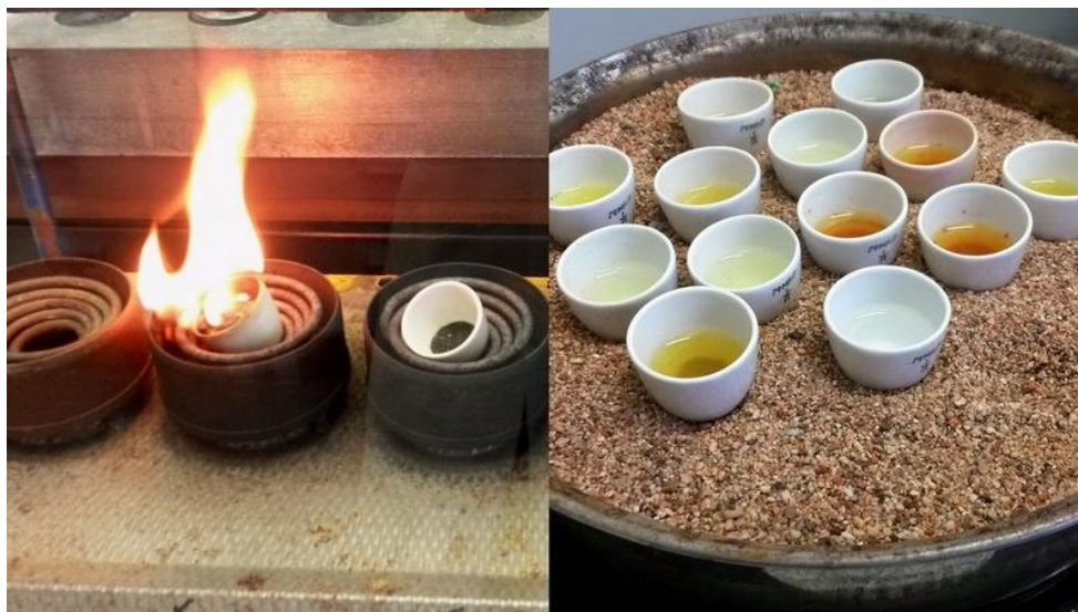
Slika 3: Sežiganje vzorcev na gorilniku in vzorci na peščeni kopeli
