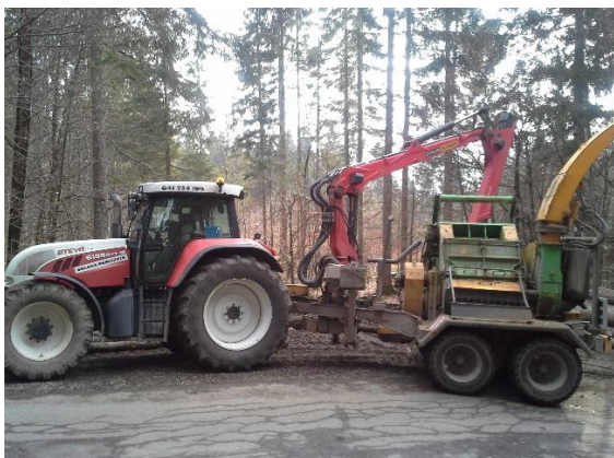
Slika 10: Sekalnik Heizohack HM 14 800 K poganja traktor CVT 6195 (foto: A. Sodja)
