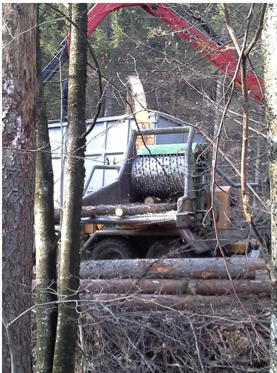
Slika 9: Vlečni valj s premerom 80 cm in široka vlečna miza (foto: A. Sodja)
