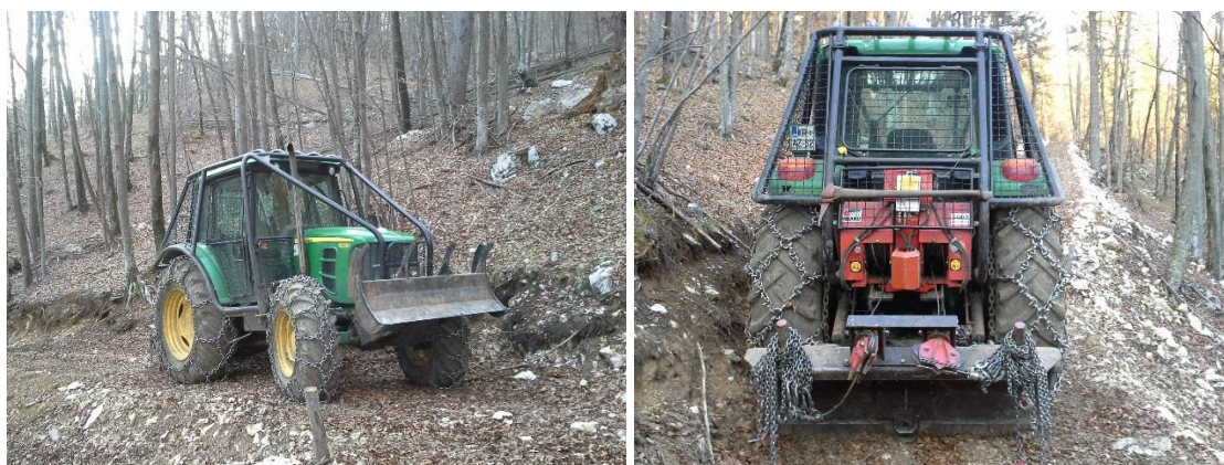
Slika 6: Prilagojen gozdarski traktor John Deere 6230 Premium (foto: A. Sodja)
