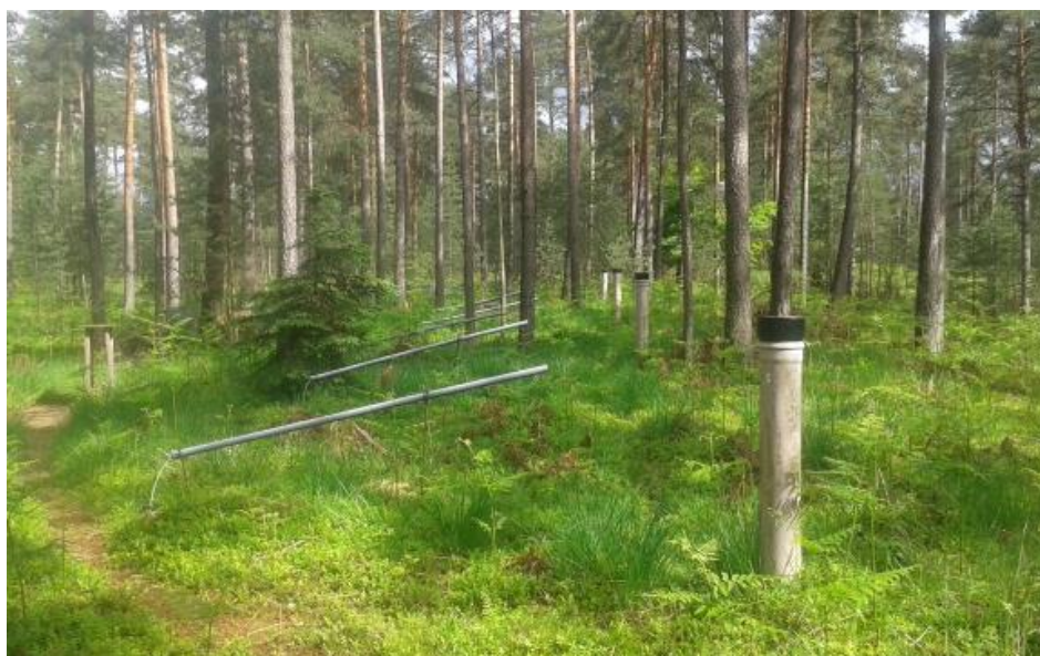
Slika 5: Linija lijev in žlebičev za merjenje prepuščenih padavin – IMGE ploskev Brdo (Vir: Rok Zupin, 2016).
