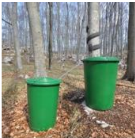
Slika 7: Prikazuje spiralni vzorčevalni trak za vzorčenje odtoka po deblu na bukvi, s plastično cevjo in sodi za zbiranje odtoka (Kovač in sod., 2011).
