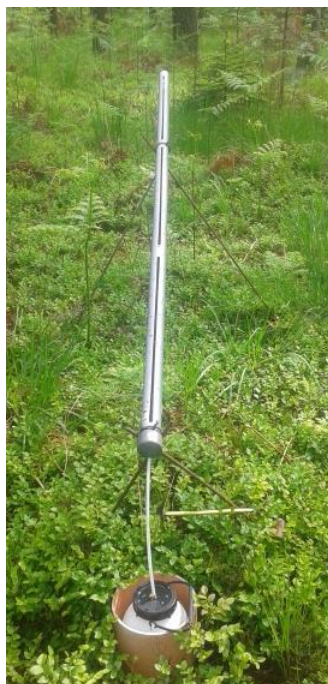
Slika 6: Žlebič za merjenje prepuščenih padavin na IMGE ploskvi Brdo (Vir: Rok Zupin, 2016).
