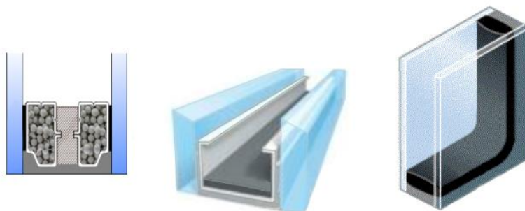
Slika 5: Distančniki s prekinjenim toplotnim mostom (Minnon, 2012)
