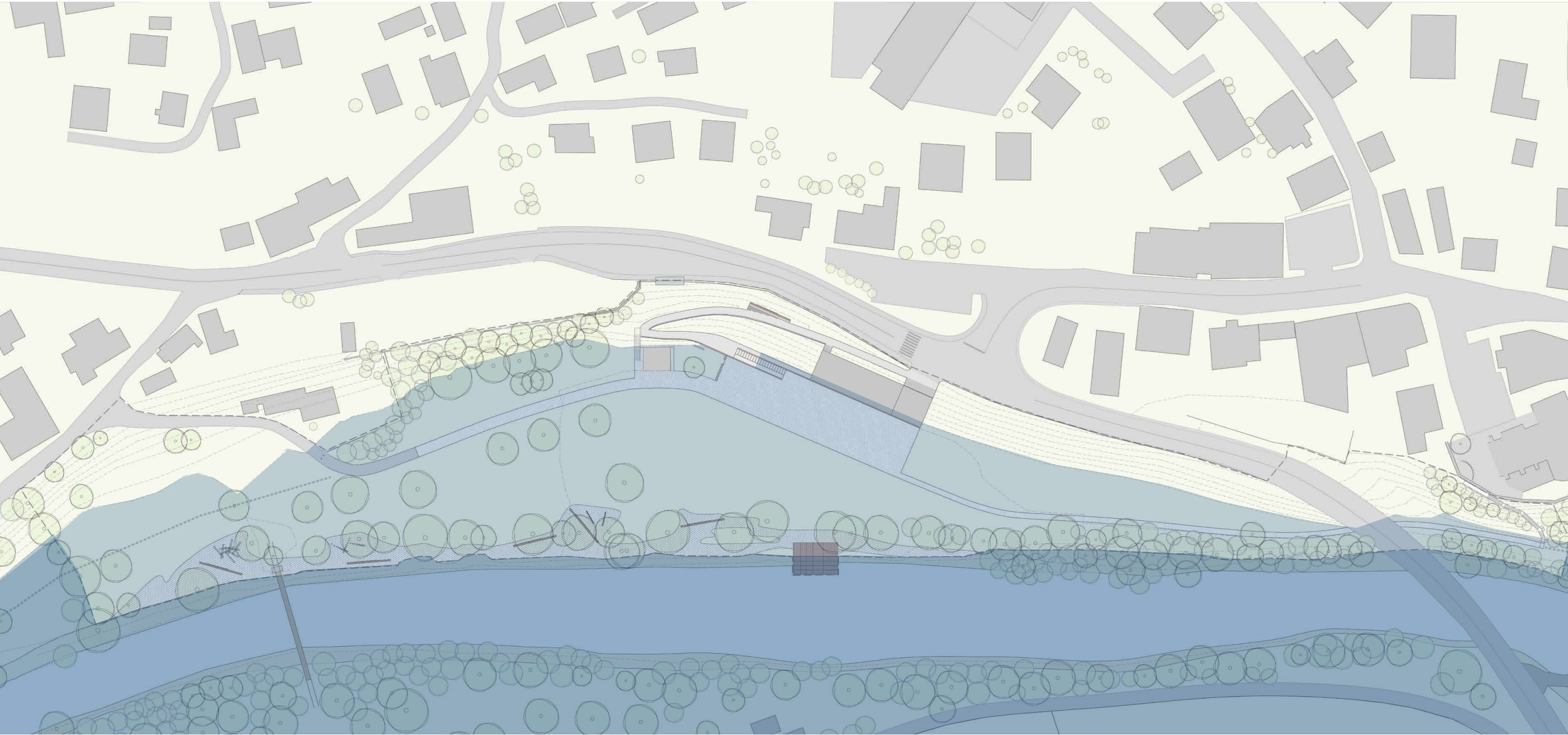
Upoštevana je višina najvišjega vodostaja ob poplavi 1990 - po označeni višini merilnega kamna
