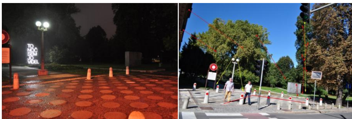
Slika 40: Prikaz trenutne osvetlitve (levo) in predlog nove postavitve svetil (desno). Zaradi neosvetljene drevnine v ozadju park ne privablja sprehajalcev. Če bi vhod ostal osvetljen s trenutno osvetljavo, bi bilo potrebno ozadje osvetliti bistveno bolj, zato sem se odločil zmanjšati nivo osvetlitve dostopa pa vendar želel ohraniti njegovo sporočilnost
