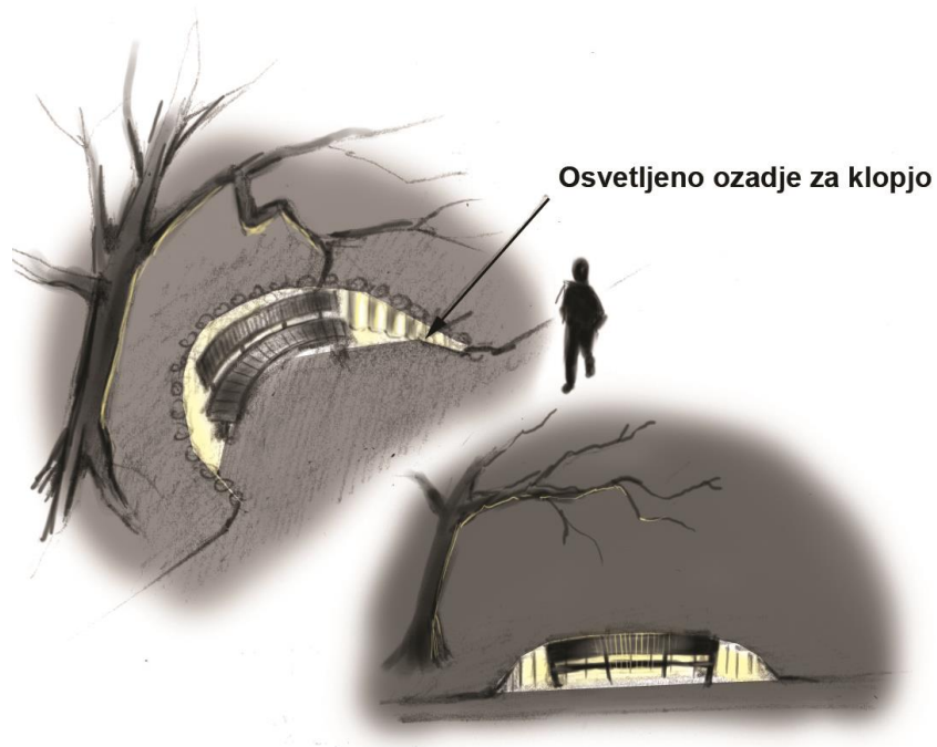
Slika 87: Pri osvetljevanju prostora za klopjo, se sprehajalcem nakaže silhueta klopi
