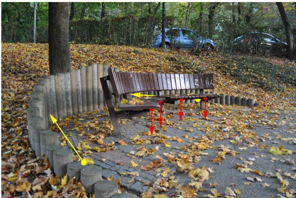
Slika 86: Prostor za klopi se osvetljuje tako, da sprehajalci že od daleč prepoznajo silhueto klopi, med sedenjem in opazovanjem pa jih osvetlitev za klopjo ne moti in se po potrebi lahko tudi zmanjša ali izklopi
