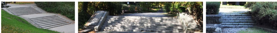
Slika 63: Prikaz vseh treh konfiguracij stopnic na območju mariborskega parka; sliki levo in desno prikazujeta nižje stopnice s počasnim vzpenjanjem, slika v sredini pa prikazuje strmejšše stopnice s hitrejšim vzpenjanjem
