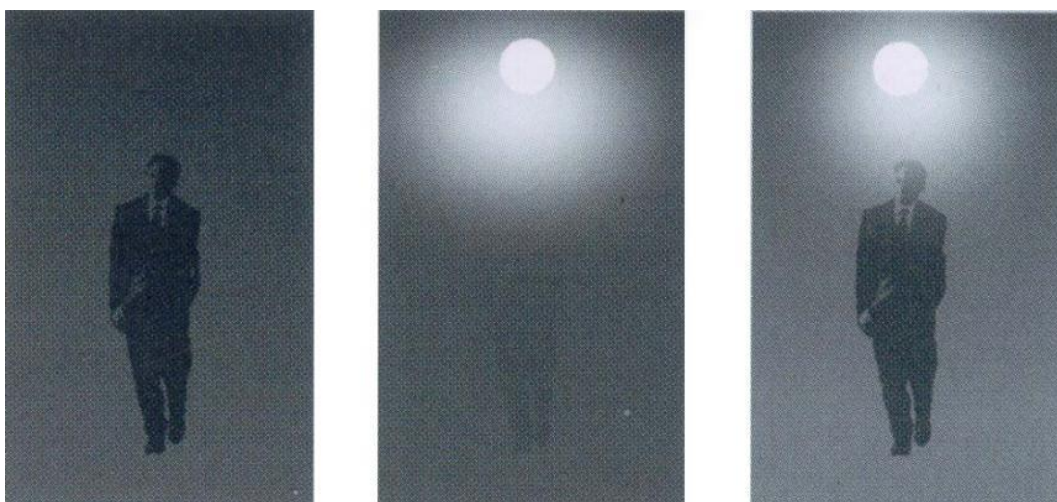
Slika 31: Bleščanje lahko zmanjša zaznavanje kontrastov; na levi sliki je kontrast ravno tolikšen, da sprehajalca opazimo, na srednji sliki pa ga zaradi močne svetlobe direktno proti našemu očesu težko opazimo. Na desni sliki je kontrast zaradi osvetljenosti okolice tolikšen, da je sprehajalec spet viden (Bizjak G., 2012c)
