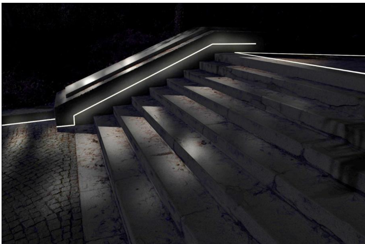
Slika 71: Prikaz bočne osvetlitve z neonskim trakom v kombinaciji z osvetljevanjem stopnic iz bližnjih dreves za boljšo vidnost
