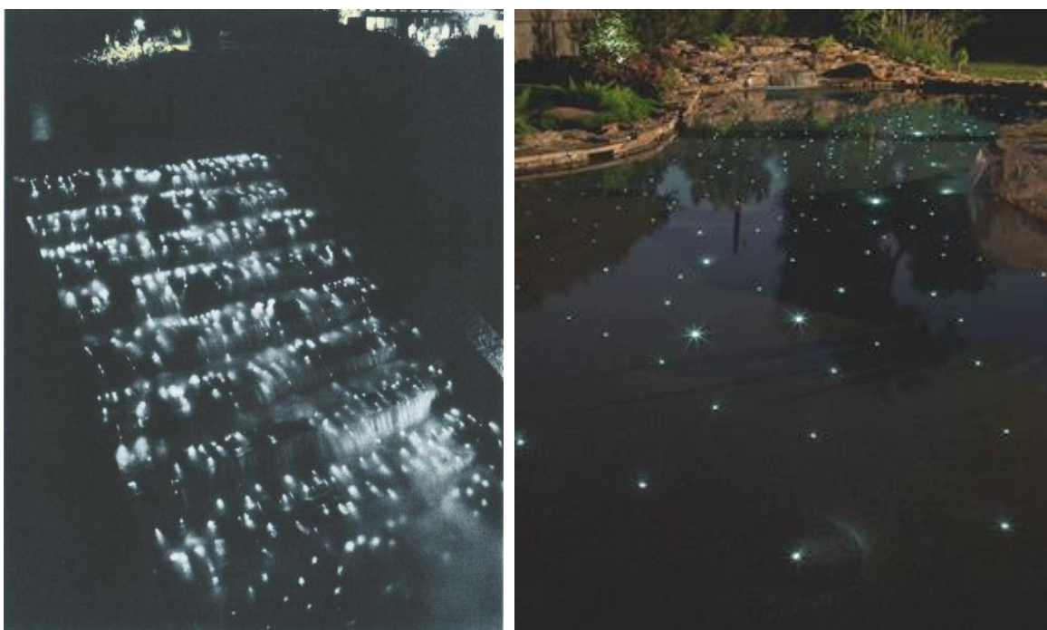
Slika 93: Dva primera rabe optičnih vlaken v tekoči (levo) in stoječi vodi (desno). Prednost je ta, da je vzdrževanje omejeno le na eno sijalko, ki je locirana izven vodne površine (Lennox Moyer, 2005 in Fiber ..., 2012)
