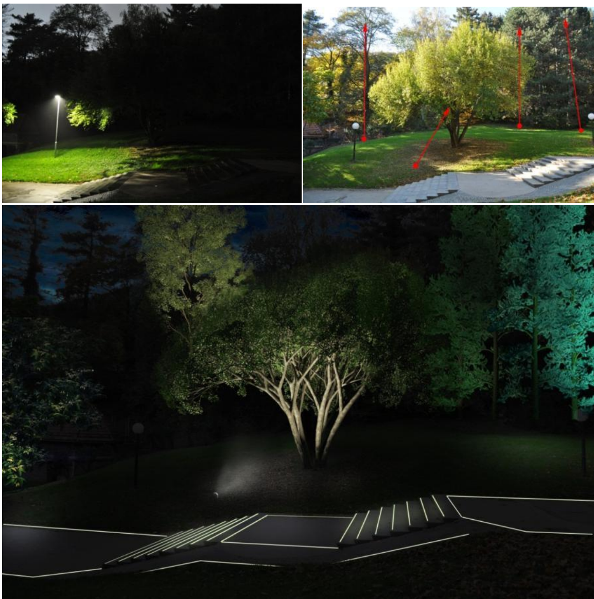
Slika 118: »Smer pogleda 4« iz primera tlorisa; slike prikazujejo osvetljen dren na glavni poti med Mestnim parkom in Tremi ribniki. Slika zgoraj levo prikazuje obstoječo osvetlitev, desno zgoraj je osvetlitvena shema po mojem predlogu in spodaj je vizualizacija postavitve svetil za prikaz parkovnega ambianta
