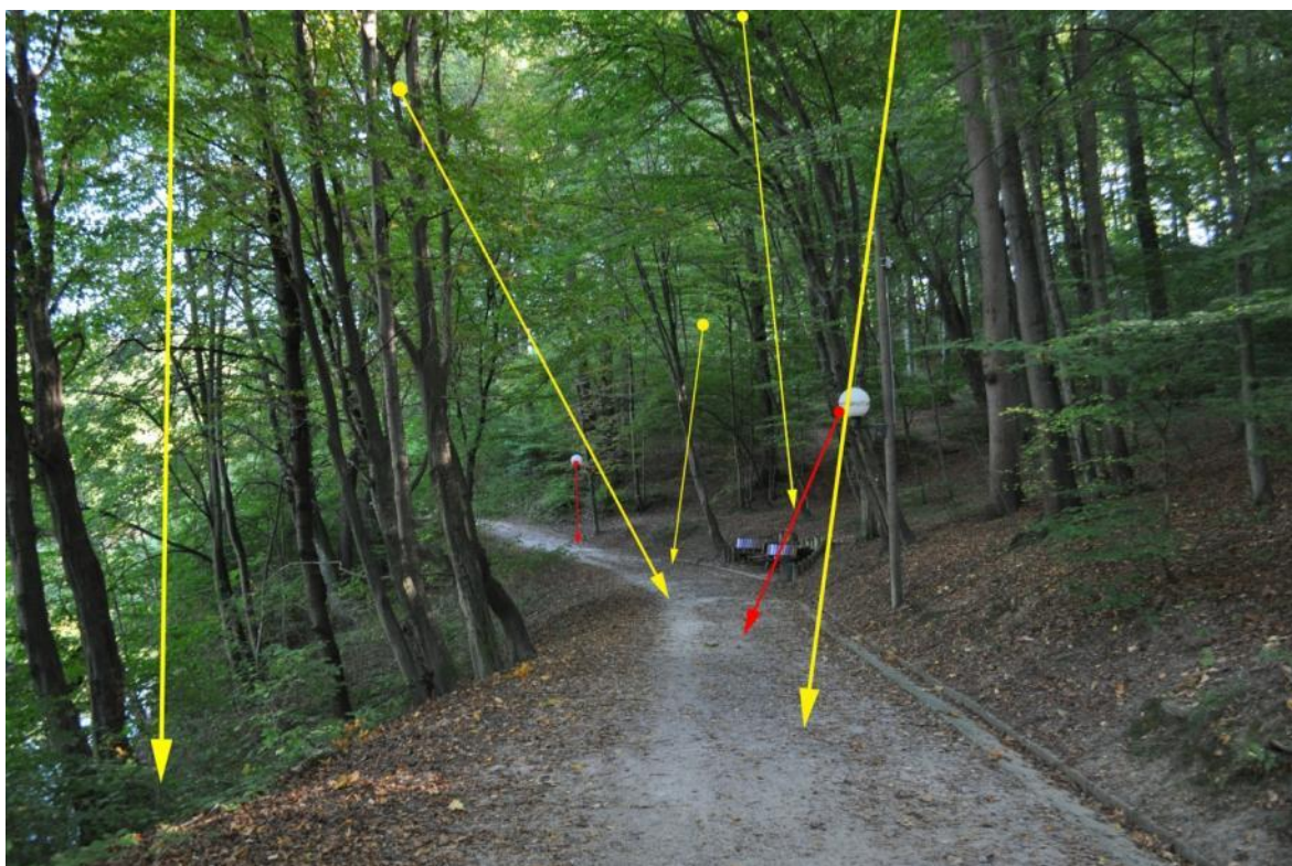
Slika 82: Rumene puščice nakazujejo osvetljevanje PAR sijalk iz drevesnih krošenj, rdeče pa komplementarno osvetlitev poti s konceptnimi krogastimi svetili
