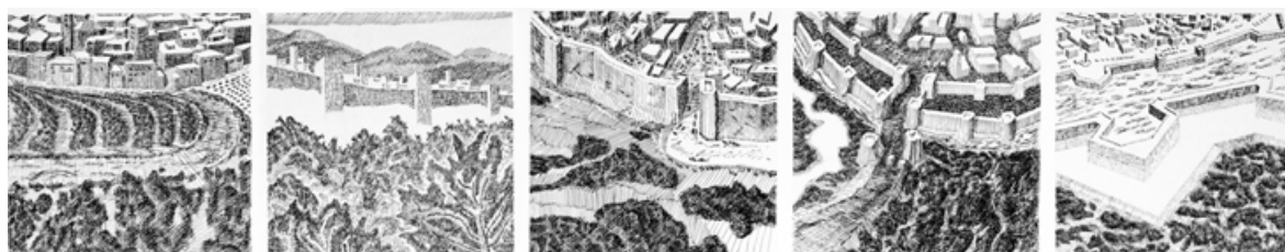
Slika 3: Oblike mestnih obzidij: A) stavbe tvorijo obrambni rob mesta; B) topografija, nadzidana z obrambno strukturo; C) enojno obzidje; D) dvojno obzidje; E) kompleksna obrambna struktura z bastioni – pozno renesančni tip (Kostof, 1992).
