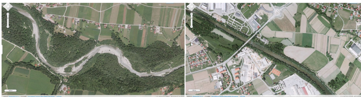
Slika 1: Zaradi pridobivanja zemljišč za kmetijsko in urbano rabo, ter posledično zagotavljanje večje poplavne varnosti, je struga Savinje regulirana (desno), oziroma poglobljena, zravnan in z utrjenimi bregovi. Pri tem so prvotne bistveno širše obrežne pasove, ki jih še vidimo na levem posnetku, v celoti odstranili, nadomestili pa so jih zelo ozki in s pionirskimi vrstami (vrbe) zarasli obrežni pasovi, ki so veliko bolj dovzetni za kolonizacijo tujerodnih invazivnih vrst (Geopedia ..., 2013).
