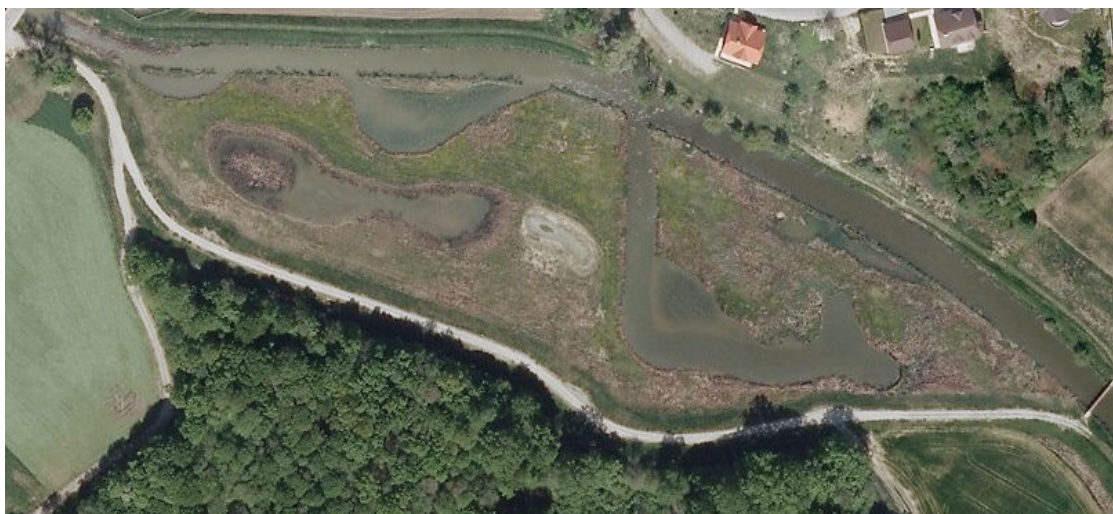
Slika 30: Primer izvedbe presihajočih mokrišč ob potoku Globovnica pri Lenartu (Geopedia, 2016).
