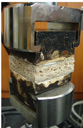
Slika 20: Ugotavljanje razslojne trdnosti (Foto: Nataša Čuk)
