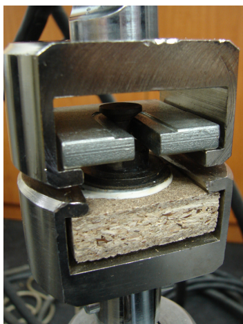
Slika 21: Ugotavljanje čvrstosti površine (Foto: Nataša Čuk)
