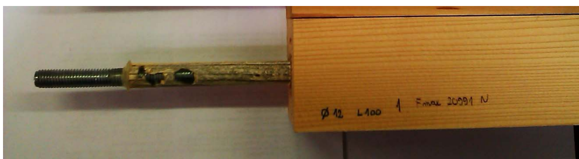
Slika 91: Ujet zrak v lepilnem sloju pri VIVJP z 0 mm debelim lepilnim slojem; \varnothing = 12 , sidriščna dolžina = 100 mm in premeru izvrtine = 12 mm
