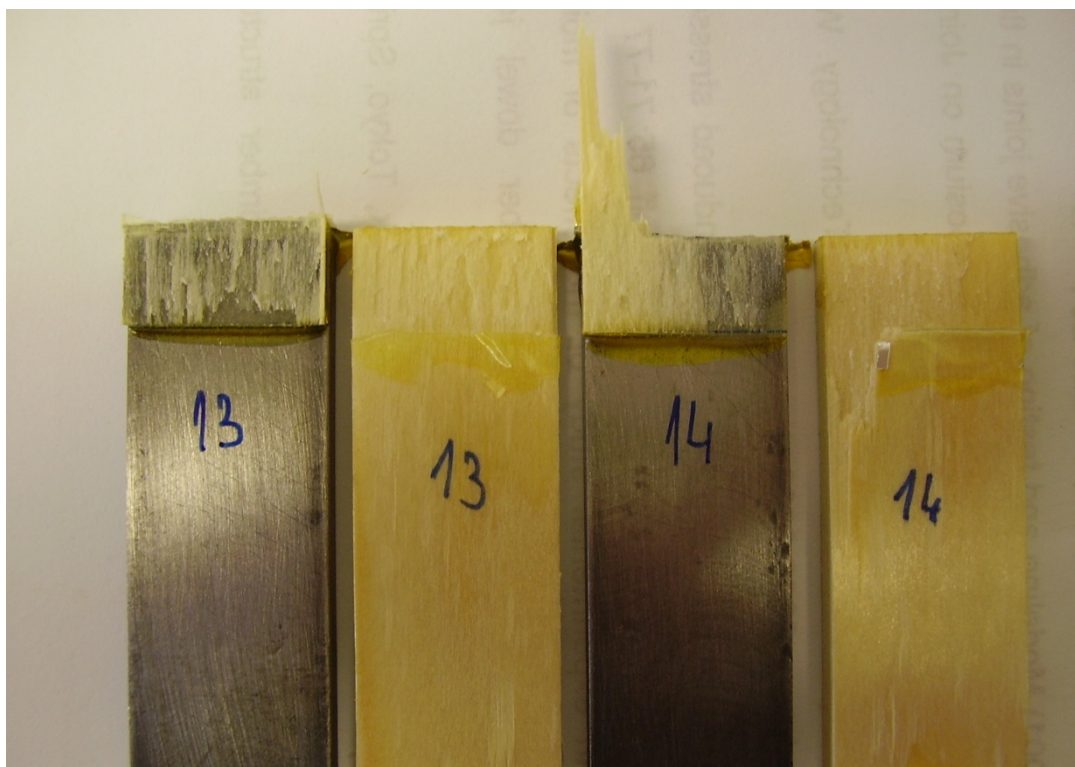
Slika 61: Preizkušanca s preklopom s tangencialno orientacijo lesnih vlaken po porušitvi na trgalnem stroju. Dobro je viden visok delež loma po lesu. Preizkušanca sta bila klimatizirana pri temperaturi 20 °C in 66 % relativni zračni vlažnosti
