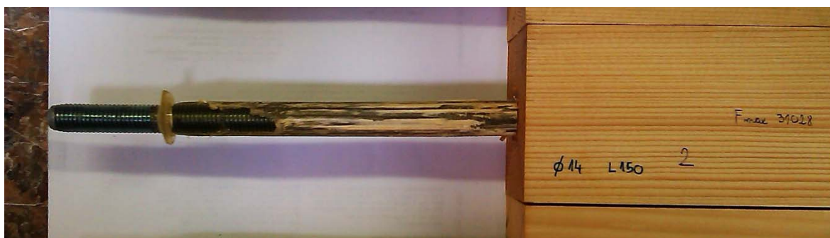
Slika 94: Ujet zrak v lepilnem sloju pri VIVJP z 1 mm debelim lepilnim slojem; Ø = 12, sidriščna dolžina = 150 mm in premeru izvrtine = 14 mm
