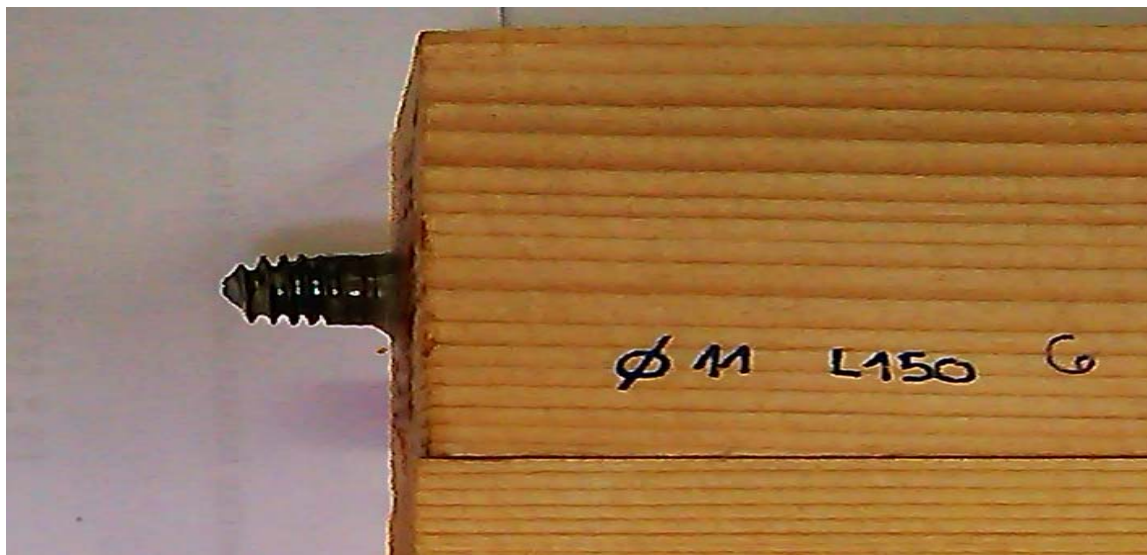
Slika 67: Porušitev v jekleni palici; \varnothing = 10 mm, premer izvrtine = 11 mm, sidriščna dolžina = 150 mm
