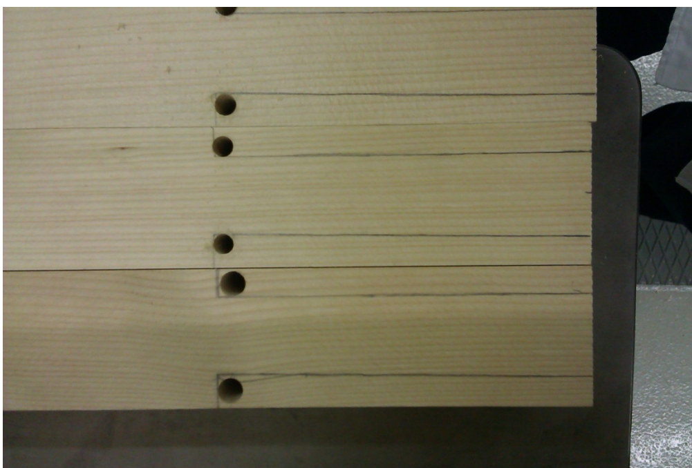
Slika 35: Izvrtine za enakomernejšo porazdelitev sil v območju vpetja preizkušanca
