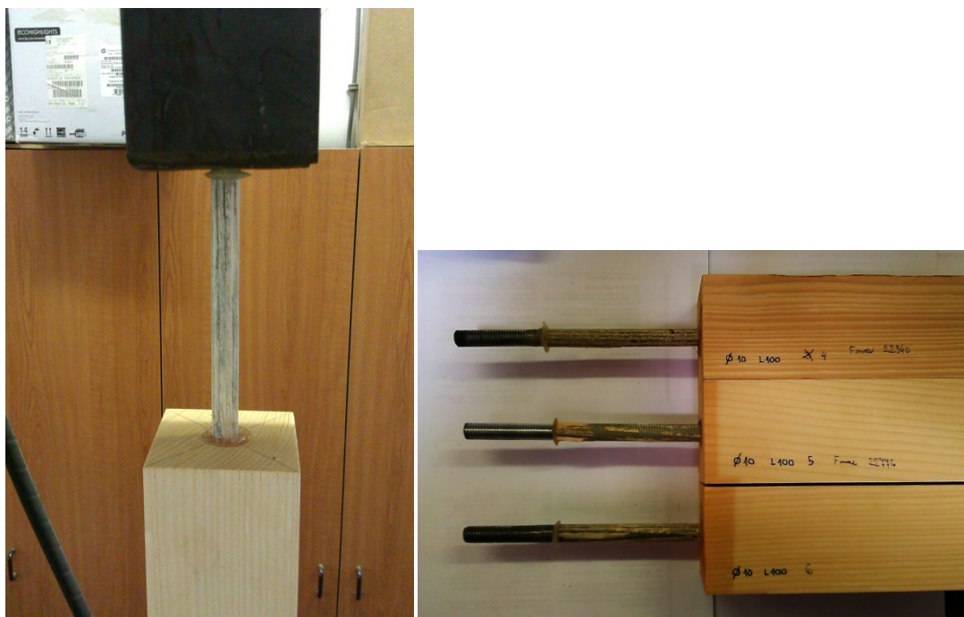
Slika 64: Tipična porušitev VIVJP po lesnih vlaknih
