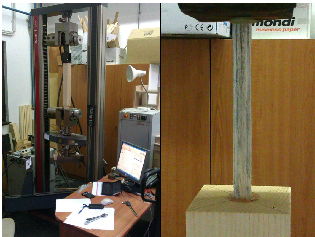
Slika 41: Merjenje mehanskih lastnosti VIVJP s trgalnim strojem Zwack Z100 in končna porušitev vezi
