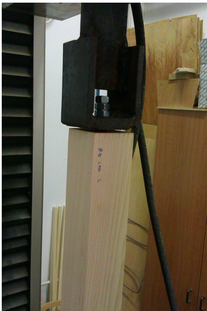
Slika 33: Čeljust za vpetje kovinskega dela VIVJP, vidna nosilna plošča in pritrditev vijaka z maticami
