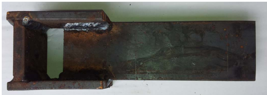
Slika 32: Čeljust za vpetje kovinskega dela VIVJP
