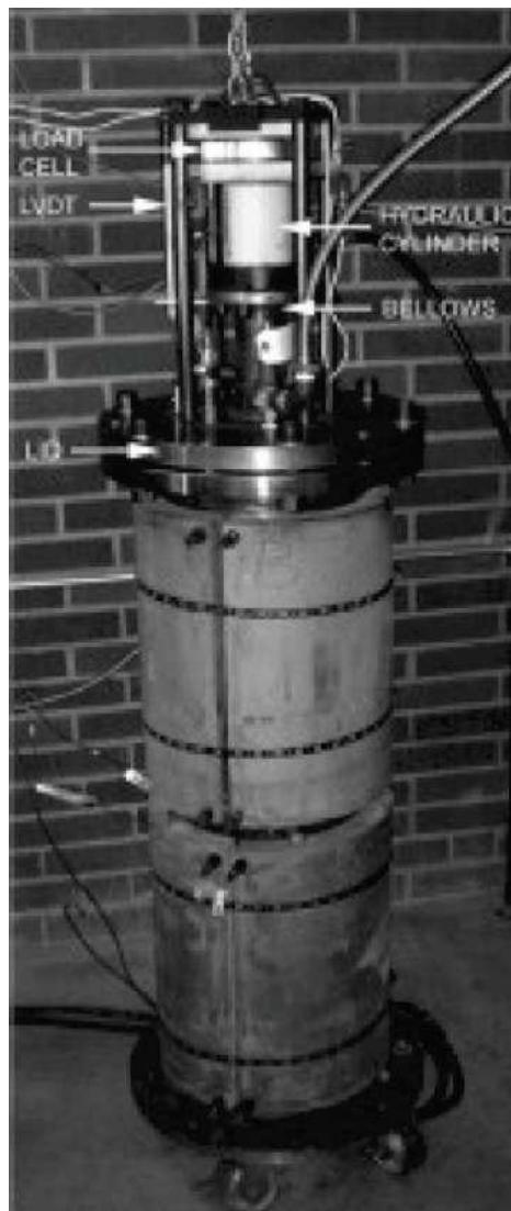
Slika 4: Naprava za izvajanje VTC (Kutnar in sod., 2010)
