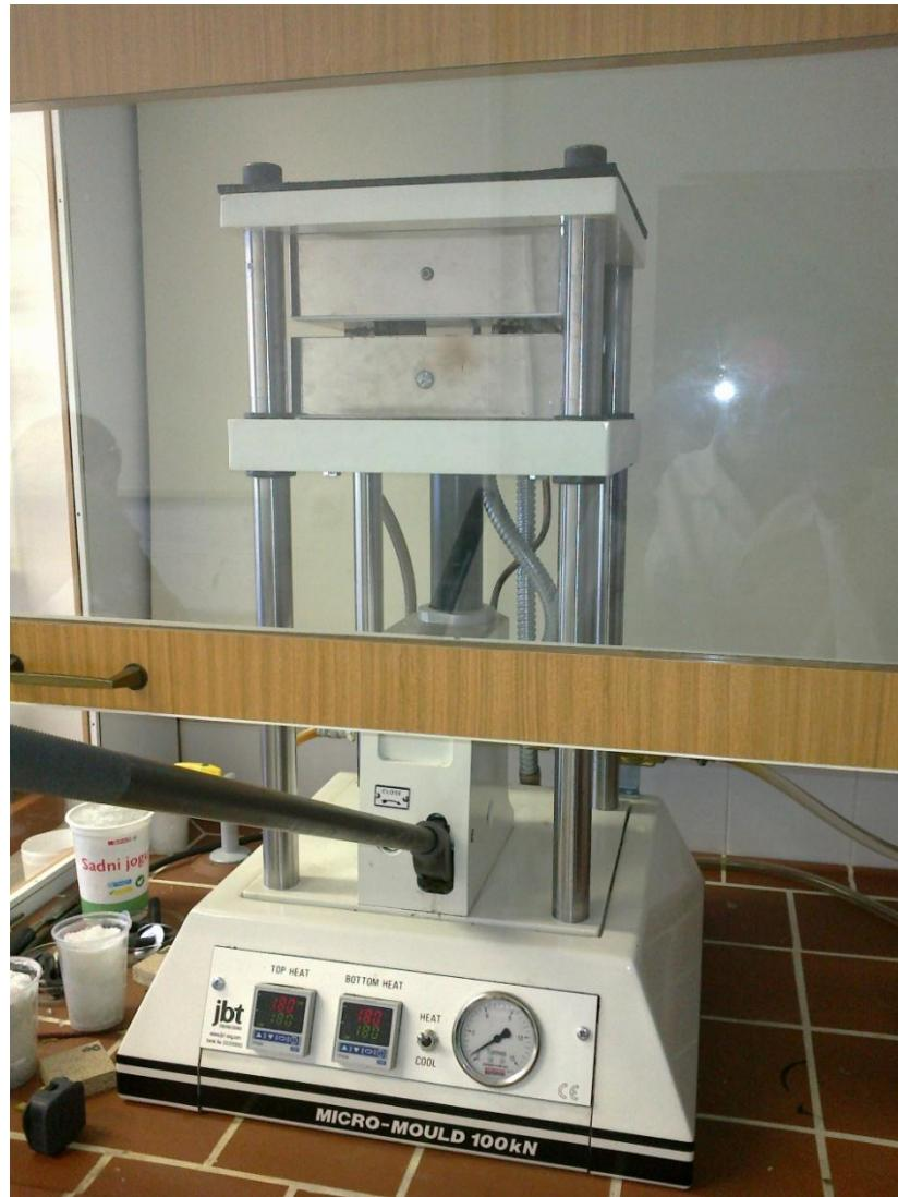
Slika 15: Stiskanje lepljencev z laboratorijsko stiskalnico
