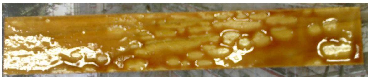
Slika 14: Nanos FF lepila na lepilno površino VTC preizkušanca
