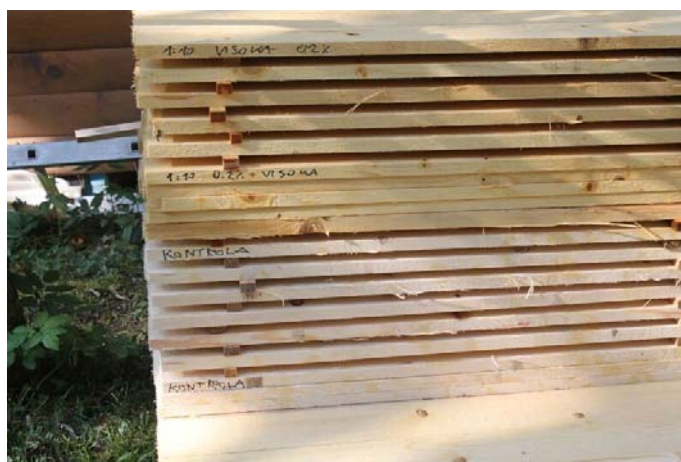
Slika 5: Letvičeni in naletvičeni vzorci za izvedbo terenskega testa
