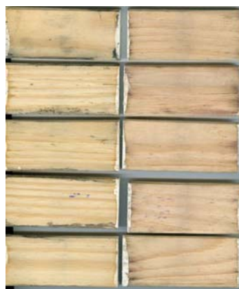
Slika 9: Levi vzorci zaščiteneh z srednjo, desno vzorci zaščiteneh z visoko koncentracijo raztopine pripravka QUAT.
