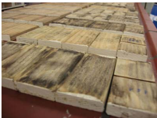
Slika 3: Čela vzorcev premazana z epoksidno smolo
