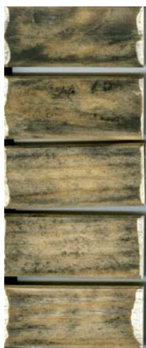
Slika 12: Vzorci zaščiteni s pripravkom nizke koncentracije raztopine EAQB
