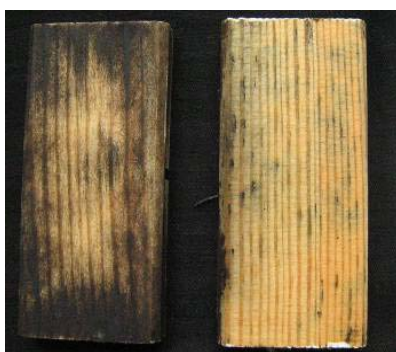
Slika 7: Primerjava kontrolnega (levo) vzorca premazanega z visoko koncentracijo (desno) pripravka Ba sestavljenega le iz borove kisline
