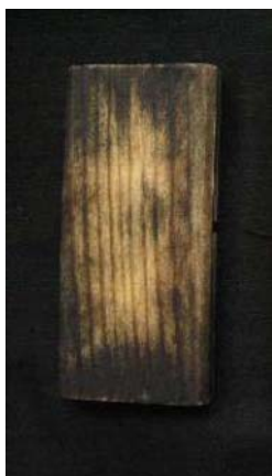
Slika 6: Izgled kontrolnih vzorcev po izpostavitvi glivam modrivkam
