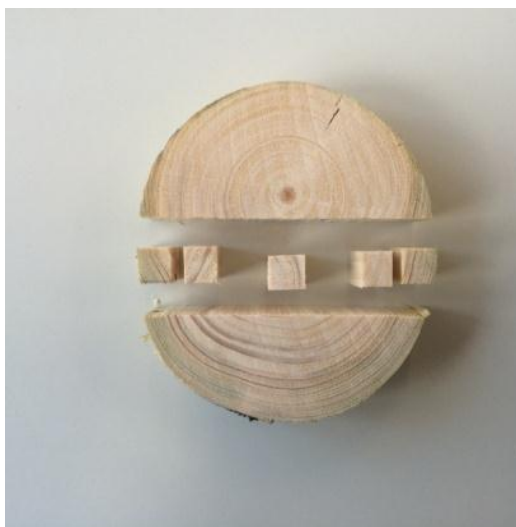
Slika 10: Vzorci pripravljeni za test izpostavitvi glivam razkrojevalkam
