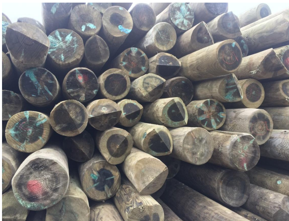
Slika 2: Telekomunikacijski drogovi impregnirani z bakrovimi pripravki po Bethellovem postopku
