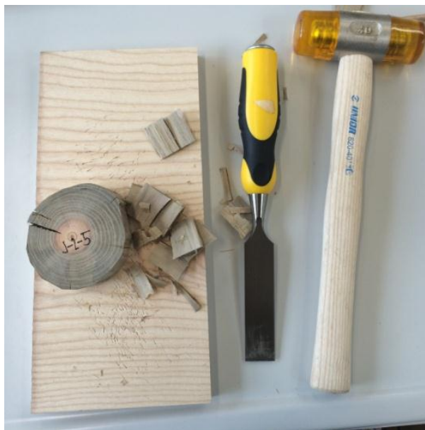
Slika 8: Priprava vzorcev za določitev vsebnosti bakra
