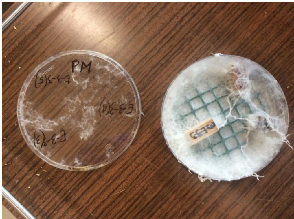
Slika 12: Razraščen micelij bele hišne gobe po vzorcih
