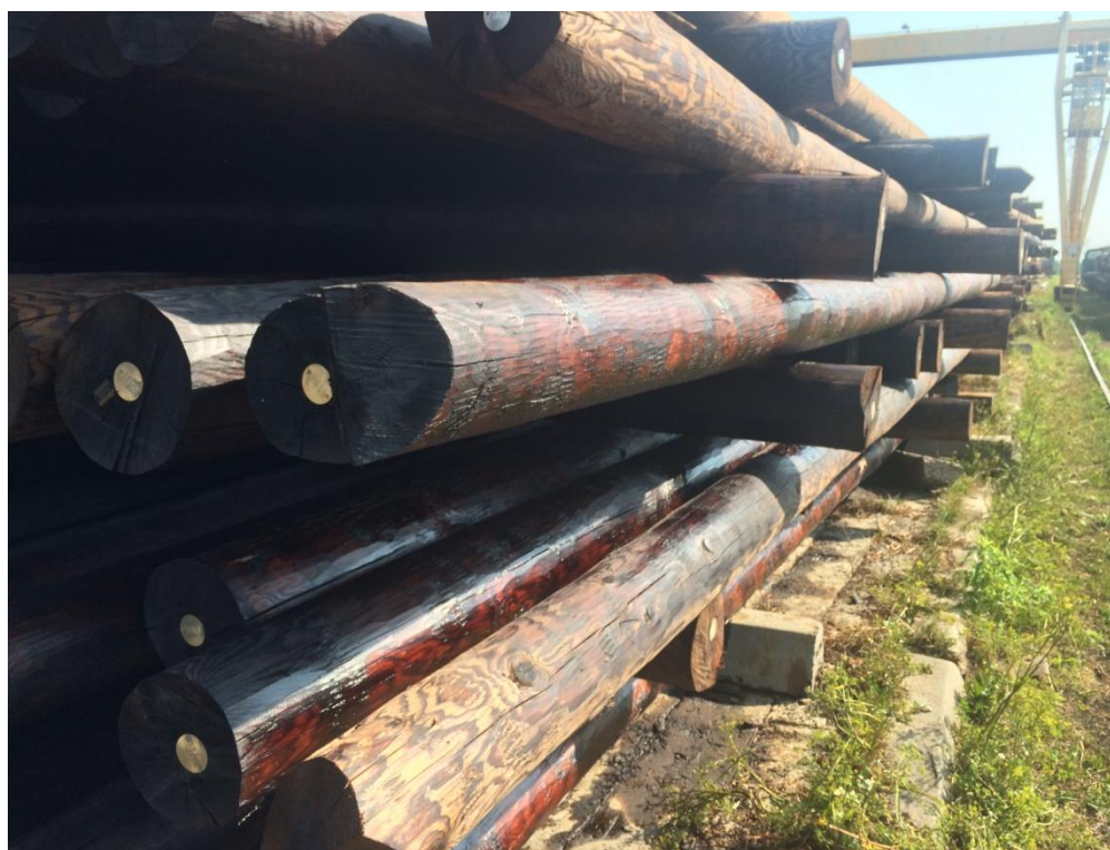
Slika 4: Telekomunikacijski drogovi impregnirani s kreozotnim oljem po Rüpingovem postopku
