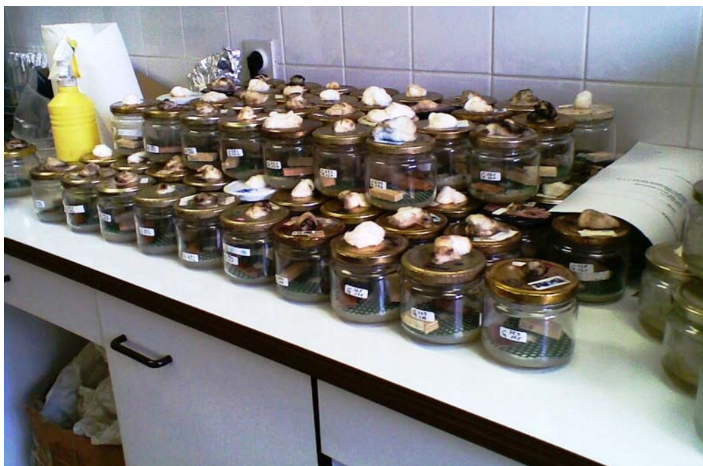
Slika 10: Kozarci z vzorci tik po izpostavitvi glivi
