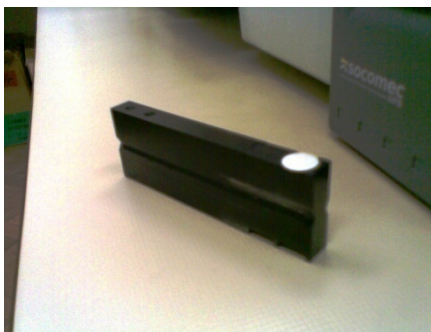
Slika 6: Samolepilni brusni papir za izvajanje FTIR spektroskopije
