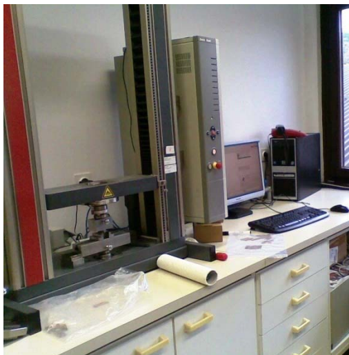
Slika 3: Univerzalni testirni stroj Zwick/Roell Z005 za merjenje mehanskih lastnosti materialov
