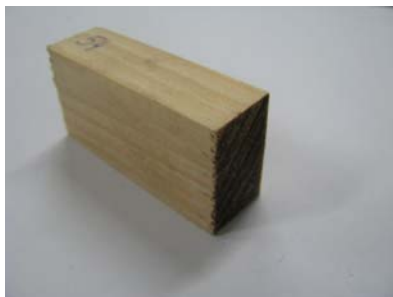
Slika 22: Impregniran vzorec pred izpostavitvijo glivam razkrojevalkam
