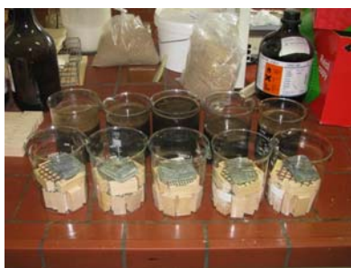
Slika 13: Vzorci, pripravljani za impregnacijo z različnimi razmerji UL, impregniranega s CCB in destilirano vodo
