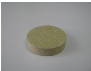
Slika 16: Vzorec za analizo XRF
