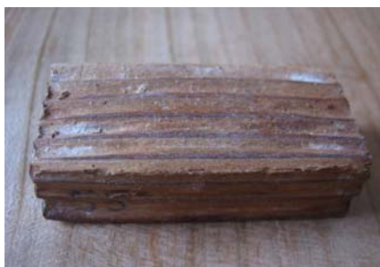
Slika 23: Impregniran vzorec po izpostavitvi glivam razkrojevalkam
