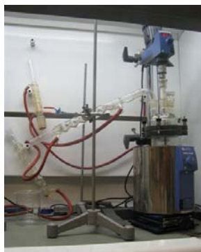
Slika 9: Sestavljena aparatura za utekočinjanje lesa
