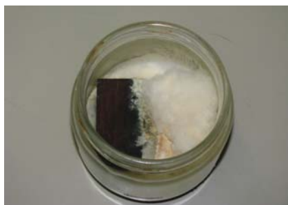
Slika 21: Kozarec z okuženima vzorcema po 16 tednih v komori
