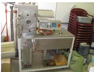
Slika 14: Vakuumsko – tlačna komora Kambič
