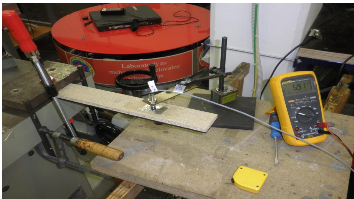
Slika 18: Merjenje iznihavanja 12 mm iverke s prilepljenim bitumnom
