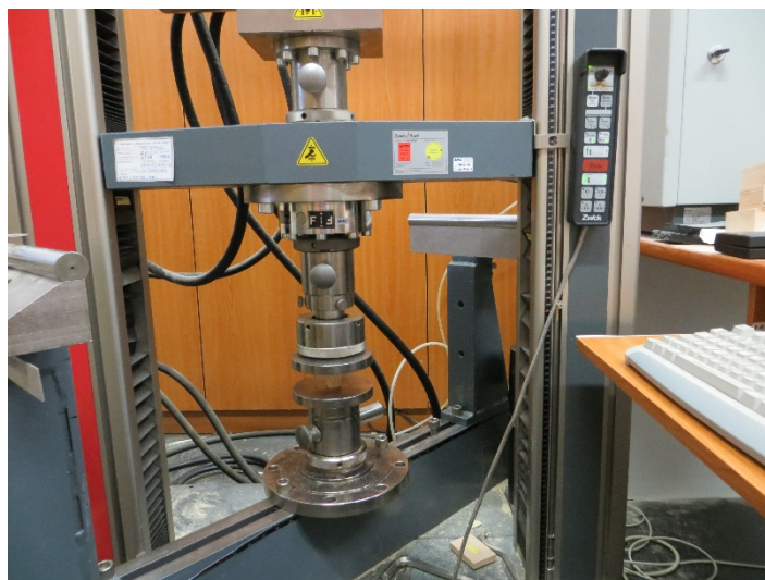
Slika 19: Izvedba tlačnega poskusa na stroju Zwick/Roell Z 100.
