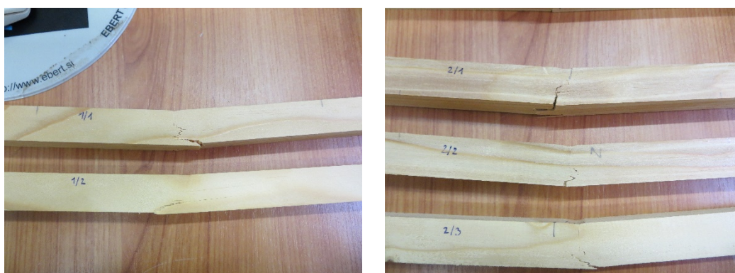
Slika 29: Prikaz prelomov preizkušancev odvzetih s stropne konstrukcije pri upogibnem preizkusu.
