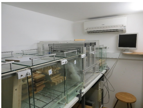
Slika 16: Stekljeni kontejnerji za uravnovešanje preizkušancev nad nasičenimi raztopinami soli.
