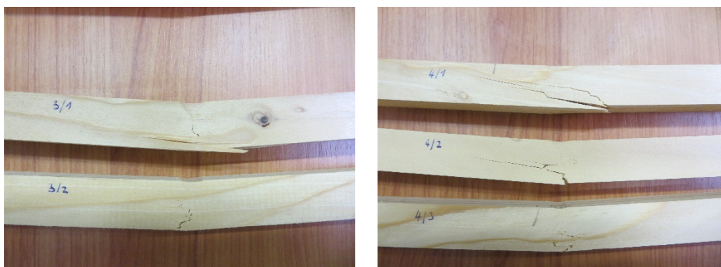
Slika 30: Prikaz prelomov preizkušancev odvzetih s stropne konstrukcije pri upogibnem preizkusu.
