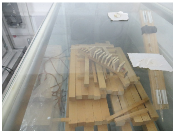
Slika 16: Stekljeni kontejnerji za uravnovešanje preizkušancev nad nasičenimi raztopinami soli.
