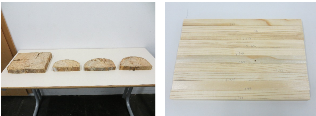
Slika 11: Pripravljene skupine preizkušancev. Levo so vzorci za dendrokronološko datiranje, desno preizkušanci za akustične in upogibne lastnosti.
