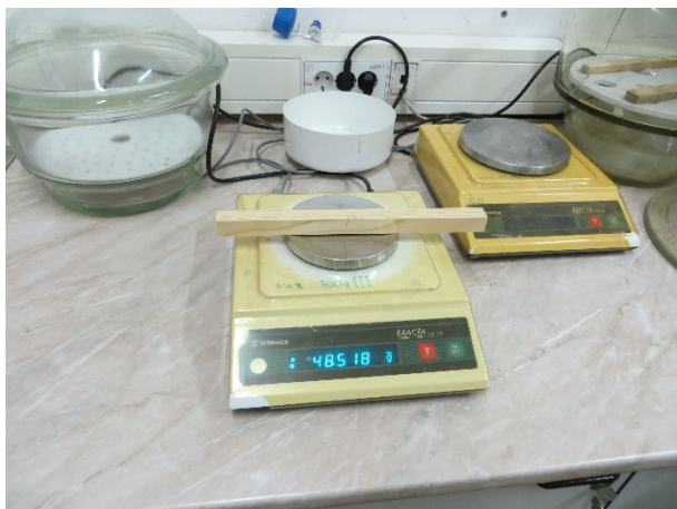
Slika 14: Tehtanje preizkušancev za določanje gostote v normalni laboratorijski klimi.
