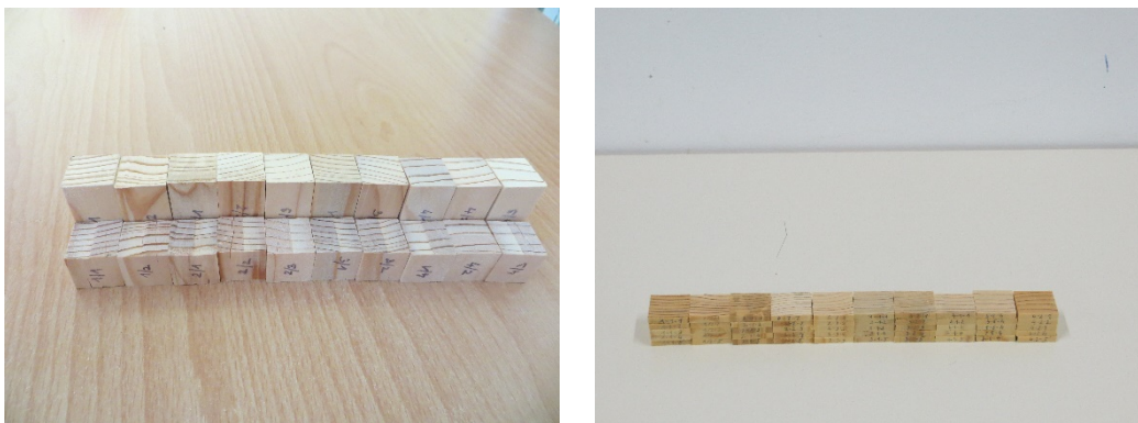
Slika 12: Pripravljene skupine preizkušancev. Levo preizkušanci za tlačne in strižne lastnosti, desno preizkušanci za dimenzijsko stabilnost.
