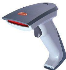
Slika 27: Laserski bralnik črtnih kod (Barcodescannerreviews, 2012)
