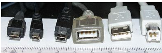
Slika 20: Vrste USB konektorjev (Wikipedia, Universal serial bus, 2012)
