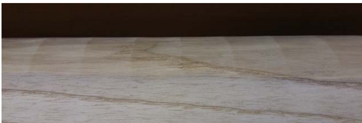
Slika 15: Valovita površina na vzorcu jesenovine
