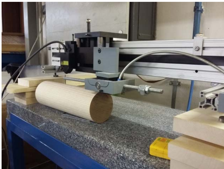
Slika 16: Laserski merilnik hrapavosti
