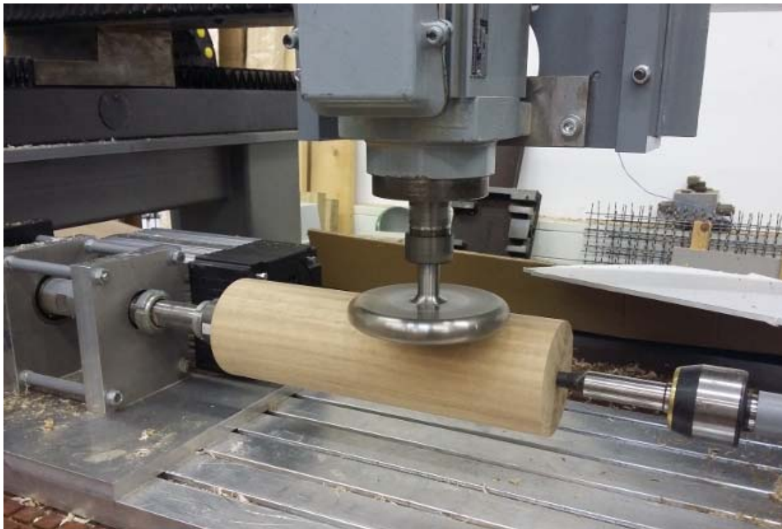
Slika 11: Struženje z gnanim orodjem
