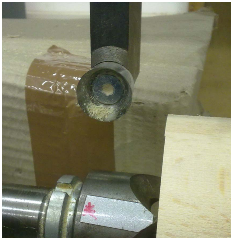
Slika 7: Rezilo za klasično struženje
