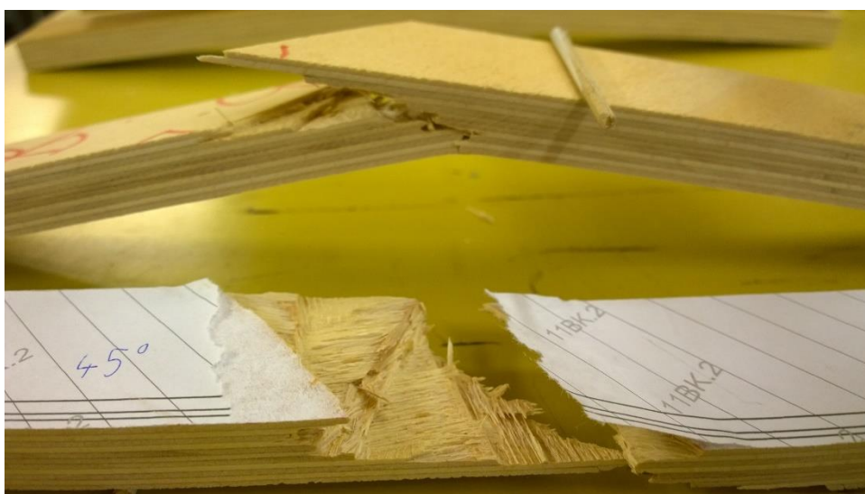
Slika 23: Porušen vzorec iz upogibnega testa.
