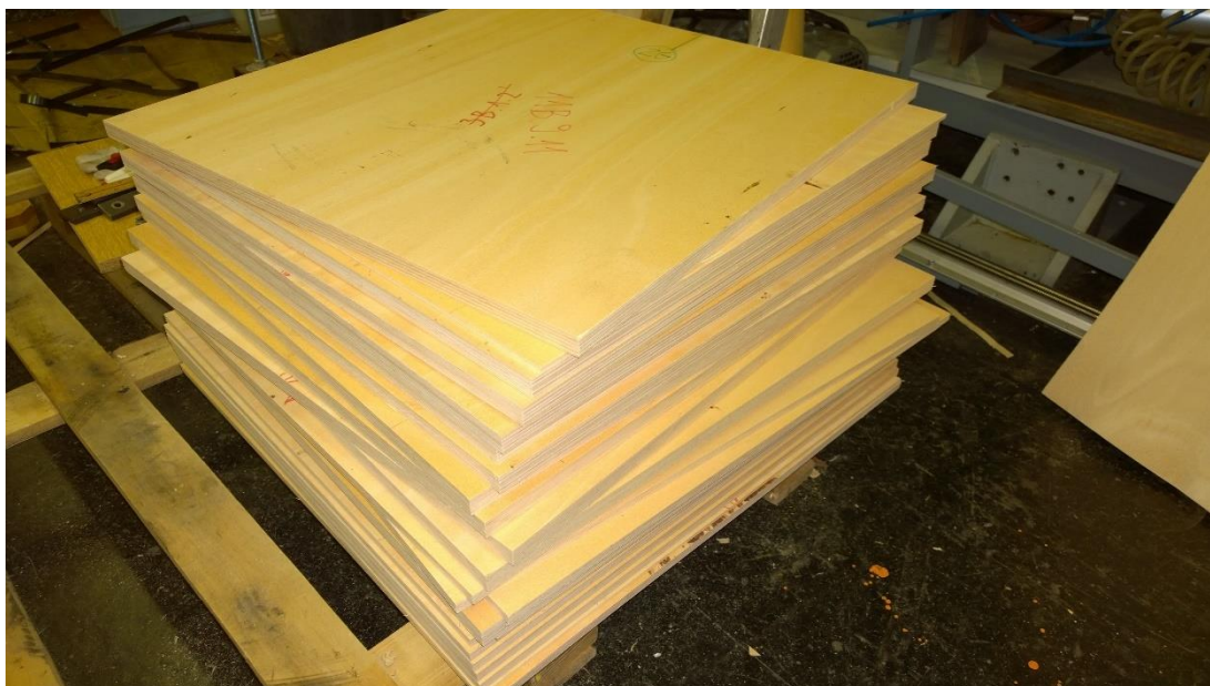
Slika 18: Izdelane furnirne plošče (550×550 mm), pripravljene za razrez vzorcev.
