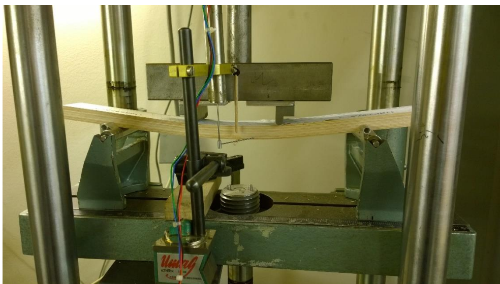
Slika 22: Vzorec na upogibnem testu v preizkuševalni napravi.
