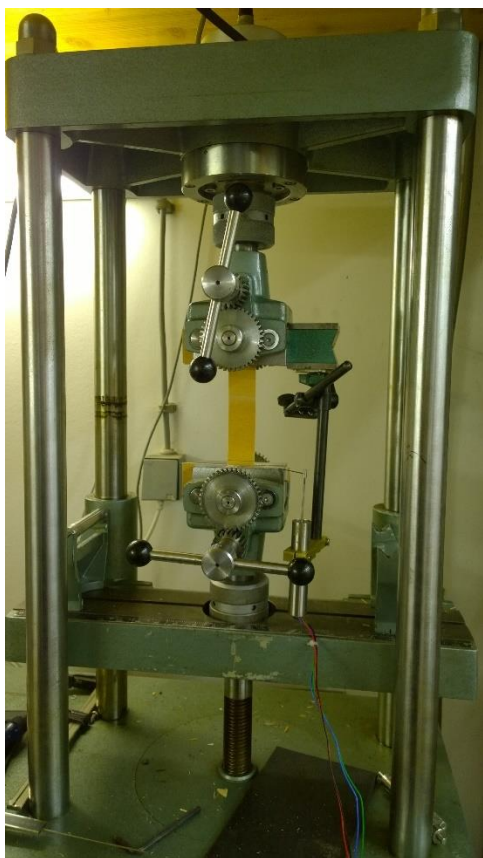
Slika 20: Natezni preizkus lista furnirja na merilnem stroju.
