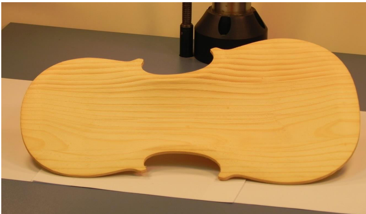
Slika 34: Spodnja (vbočena) površina violinskega pokrova iz enorobotskega sistema
