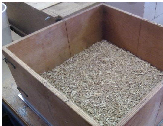
Slika 3-1: Prikaz lesenega okvira za izdelavo preizkušancev
