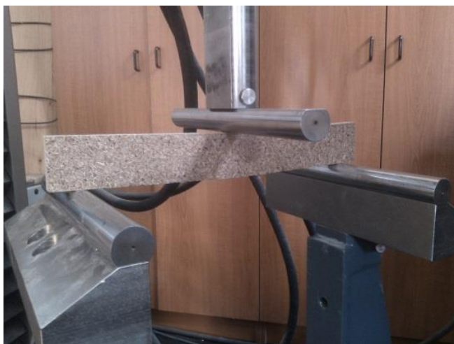
b) Merjenje upogibne trdnosti po robu
