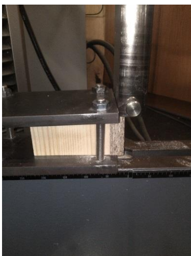
c) Merjenje strižne trdnosti po debelini
