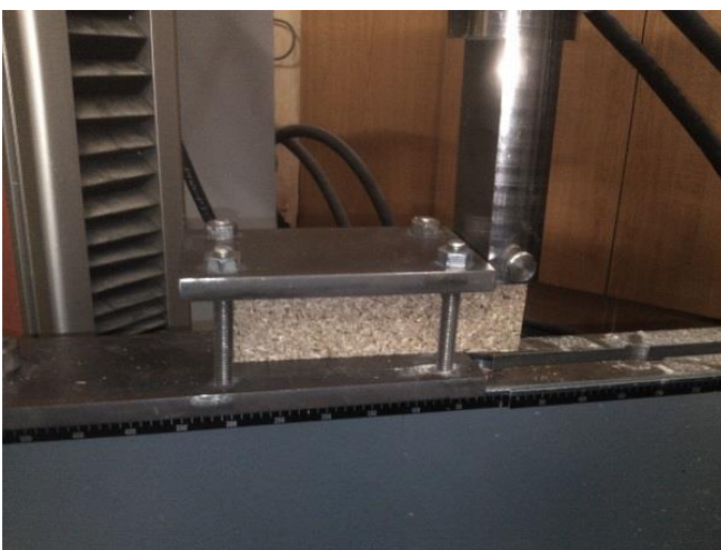
d) Merjenje strižne trdnosti po dolžini
