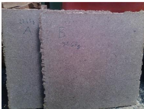
Slika 3-2: Prikaz preizkušancev, kontrolne plošče A in plošče B, pri kateri smo zunanjemu sloju dodali 30 % iverja sestave srednjega sloja
