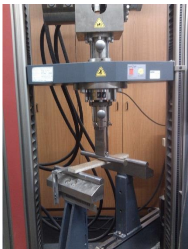
a) Merjenje upogibne trdnosti po ploskvi
