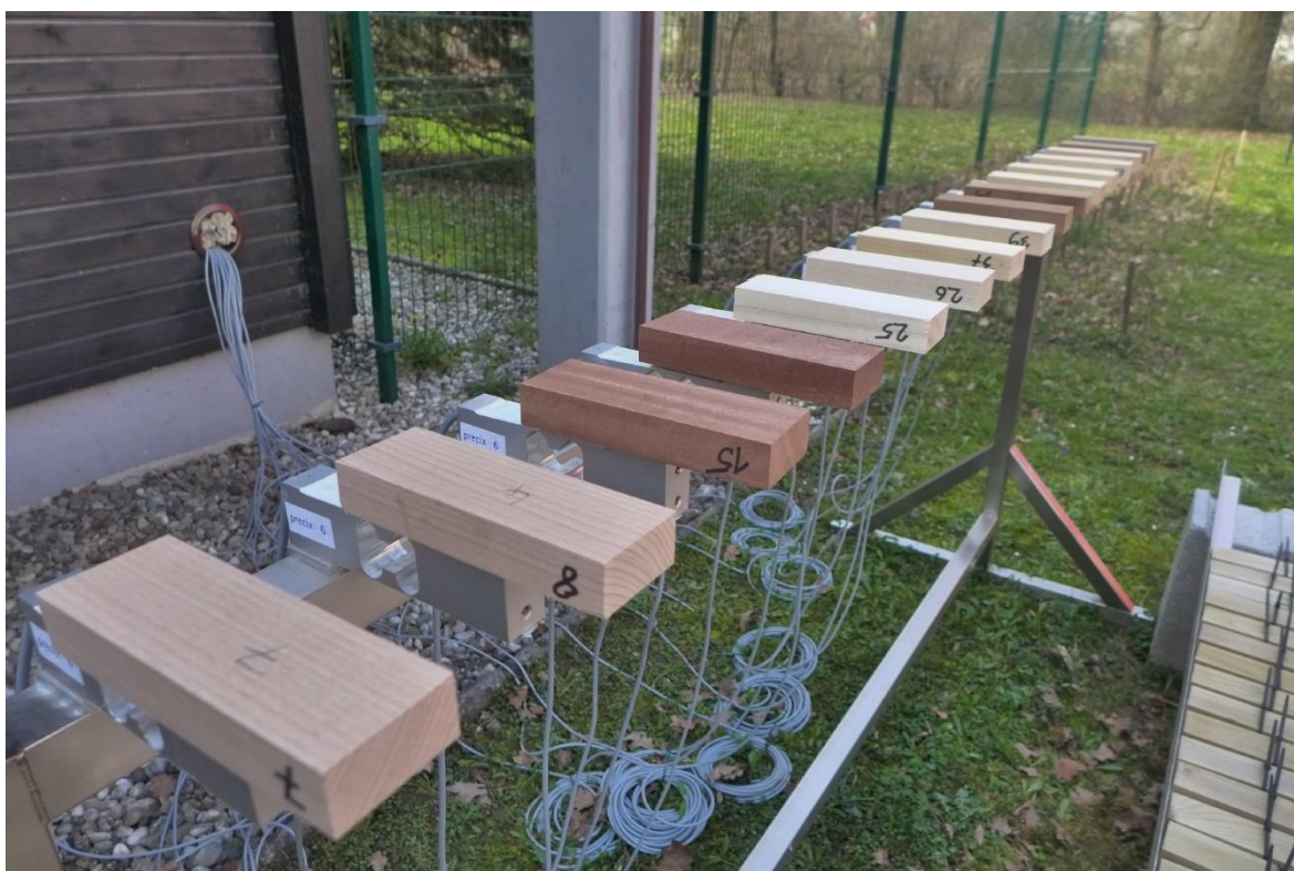
Slika 2: Kontinuirano tehtanje vzorcev (foto: Humar Miha)
