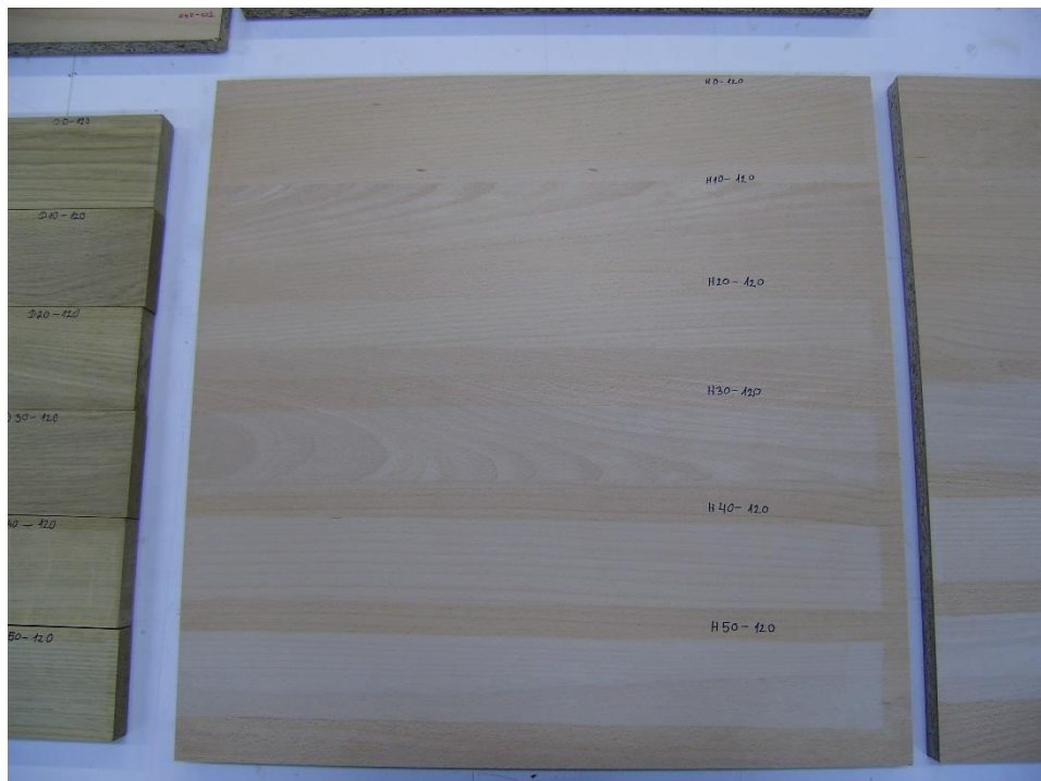
Slika 17: Primer 120 \mu\text{m} debelega nanosa laka na vodni osnovi, s koncentracijami pigmenta od 0 % do 50 %
