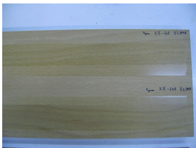
Slika 26: Končni lak, 5 % pigmenta, nanos 40 \mu\text{m} in 240 \mu\text{m} , 5 % omakala
