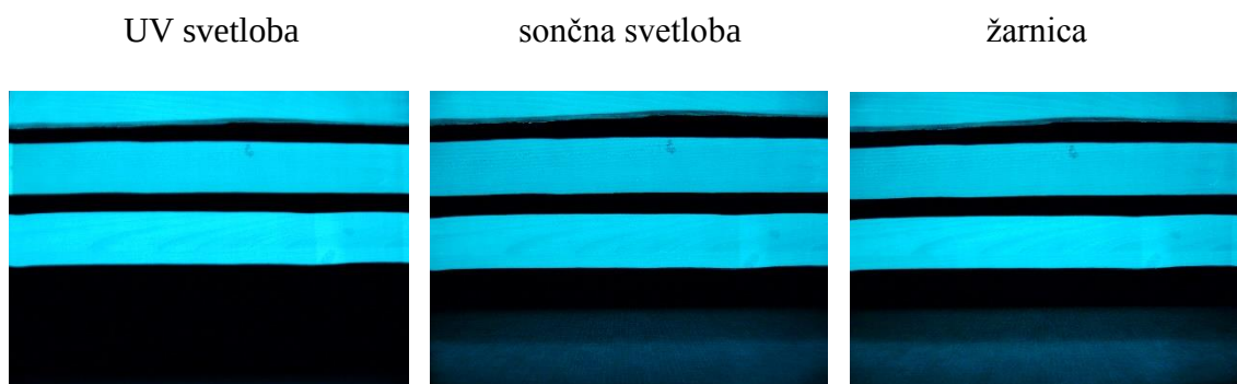
Slika 32: prikaz luminiscentnega efekta v odvisnosti od obsevanja s svetlobo iz različnih virov
