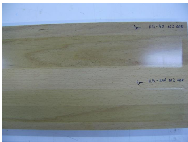
Slika 27: Končni lak, 5 % pigmenta, nanos 40 \mu\text{m} in 240 \mu\text{m} , 10 % omakala
