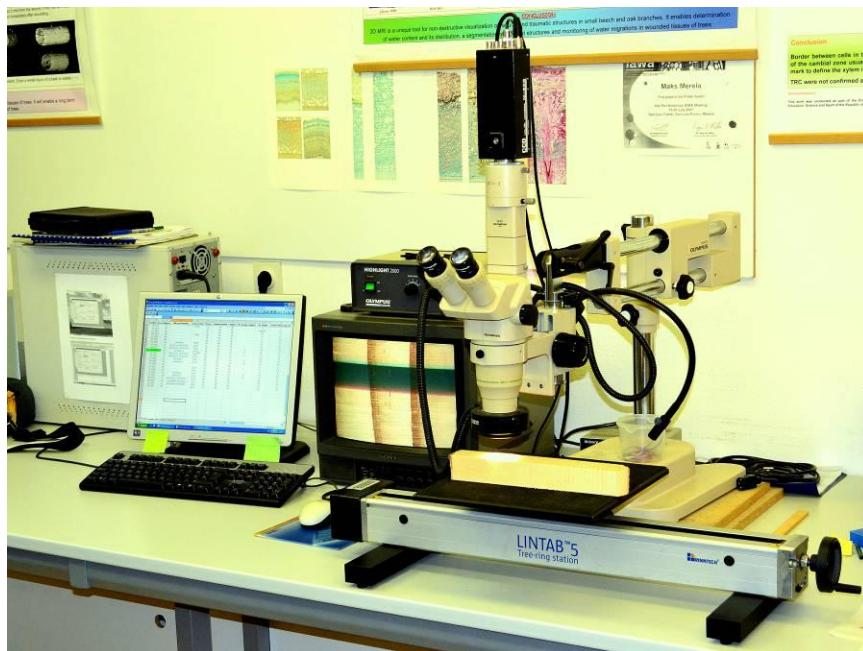
Slika 13: Merilne naprave od leve proti desni: računalnik, merilna mizica, mikroskop s kamero.
