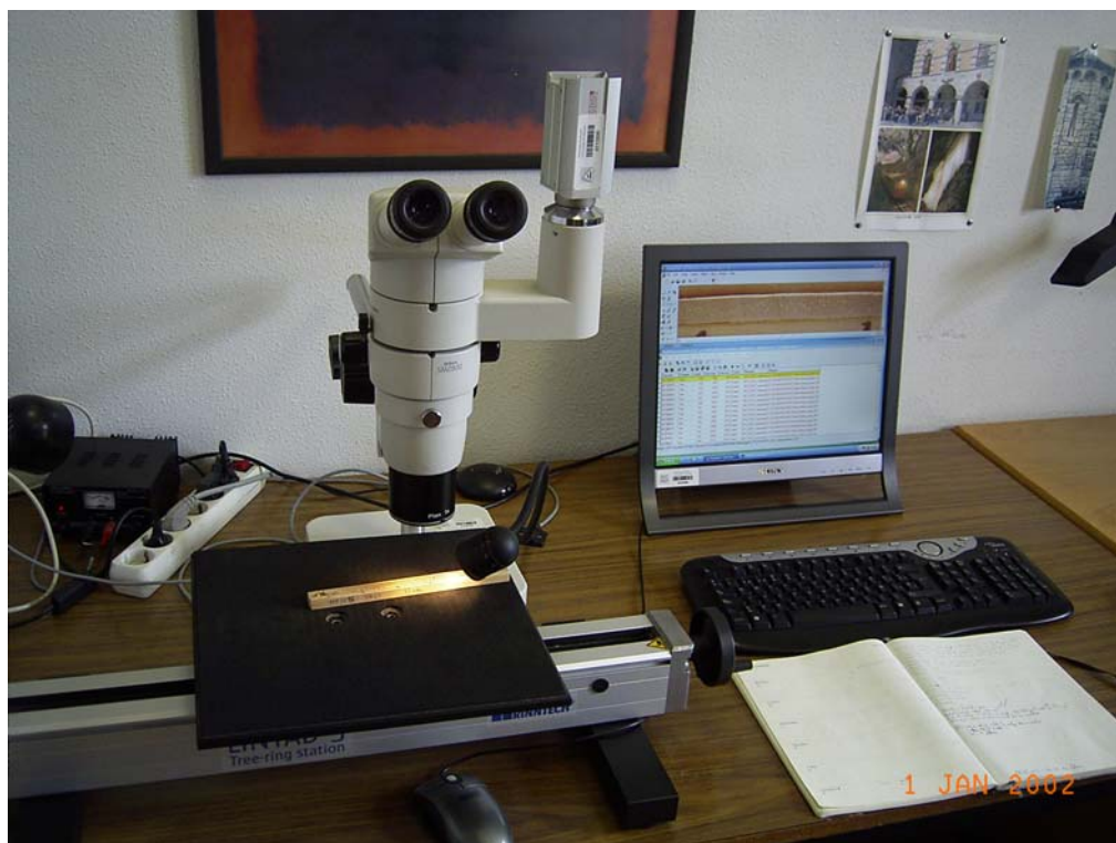
Slika 17: Merilne naprave za merjenje širin branik na izvrtkih
