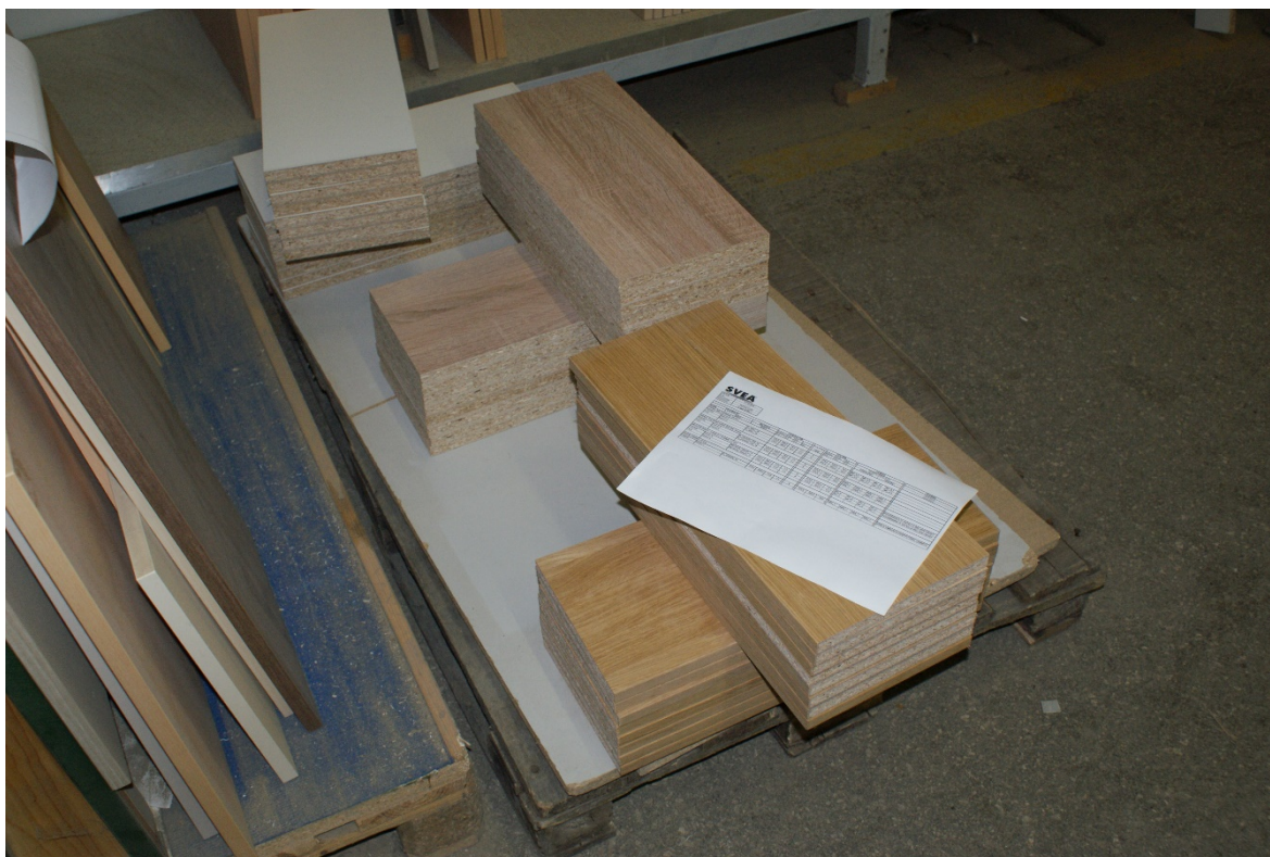
Slika 3: Iverne plošče obložene z melaminsko folijo in s hrastovim furnirjem, razžagane na dimenzije preskušancev.
