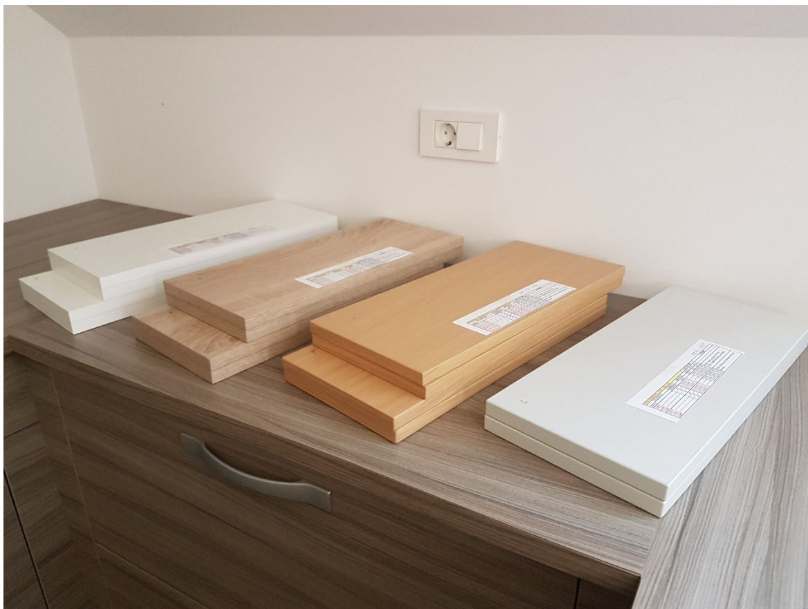
Slika 4: Iverne plošče, robno oblepljene z 0,3 mm melaminskim trakom, 1 in 2 mm ABS trakom ter 2 mm hrastovim furnirnim trakom, razžagane na dimenzije preskušancev.
