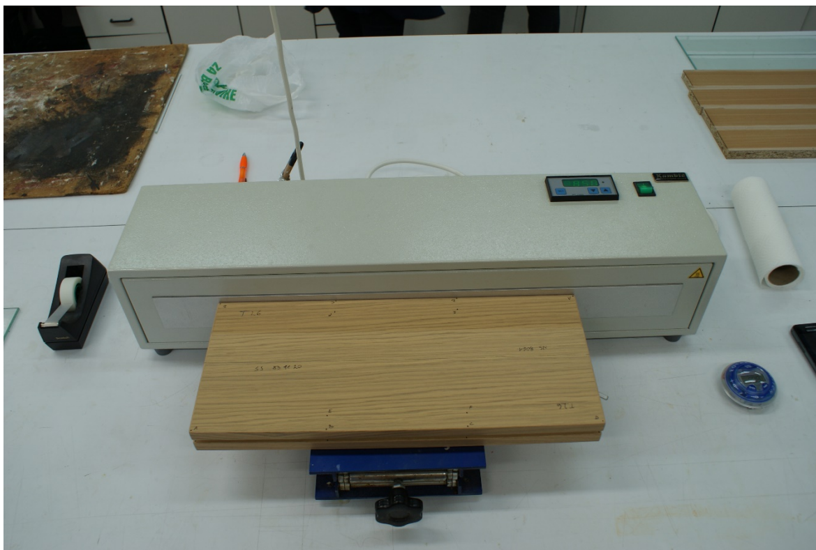
Slika 9: Naprava GP-70/6 in robni ploskvi preskušancev v stiku z grelno ploščo.
