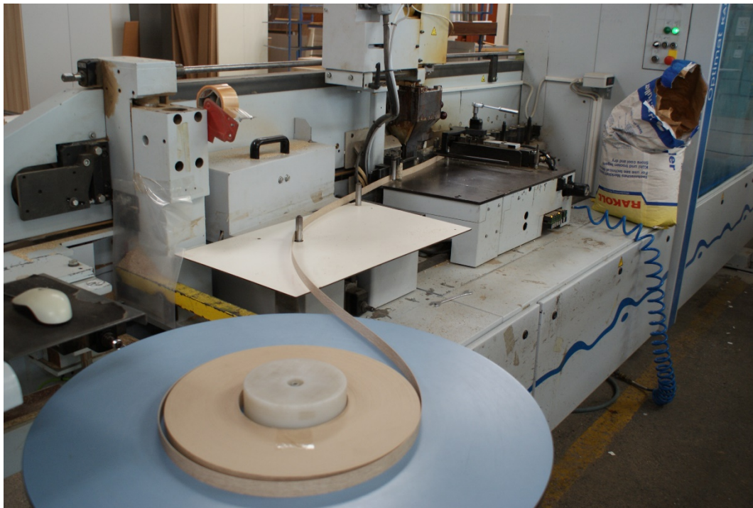
Slika 13: Robna obdelava preskušancev iz iverne plošče obložene z melaminsko folijo v lesnem dekorju z 1 mm ABS trakom in s plastomernim lepilom za robno obdelavo Rakoll TE 5700 (2).
