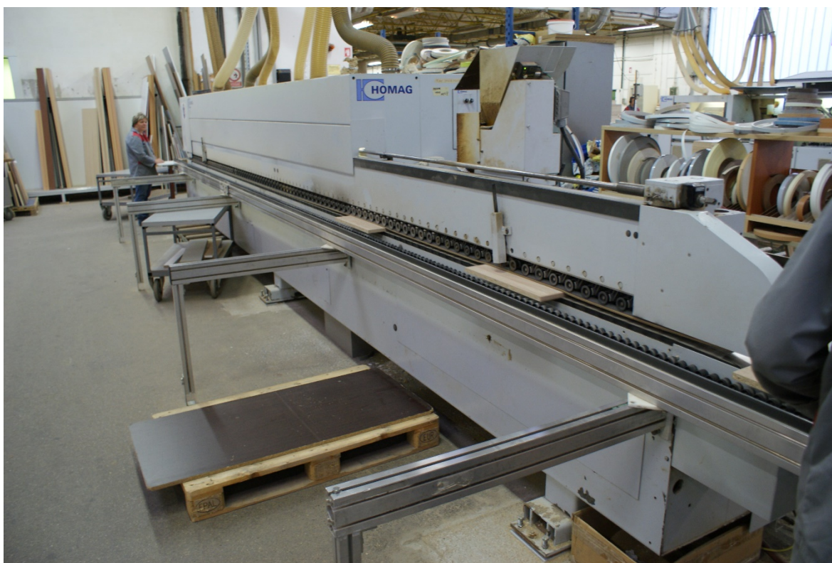
Slika 12: Robna obdelava preskušancev iz iverne plošče obložene z melaminsko folijo v lesnem dekorju z 1 mm ABS trakom in s plastomernim lepilom za robno obdelavo Rakoll TE 5700 (1).
